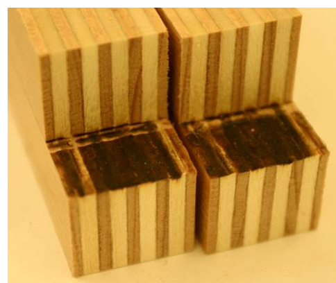
Figure 107: Test de cisaillement sur le contreplaqué non soudé (à droite) et soudé (à gauche) sur chant.
