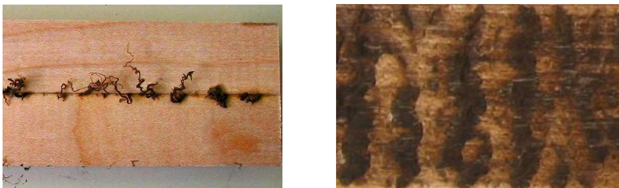
Figure 49: Matériel extrudé sortant de l'interface (à gauche), vagues formées par le matériau fondu sur la surface d'une éprouvette ouverte soudée avec un temps de soudage court (à droite).
