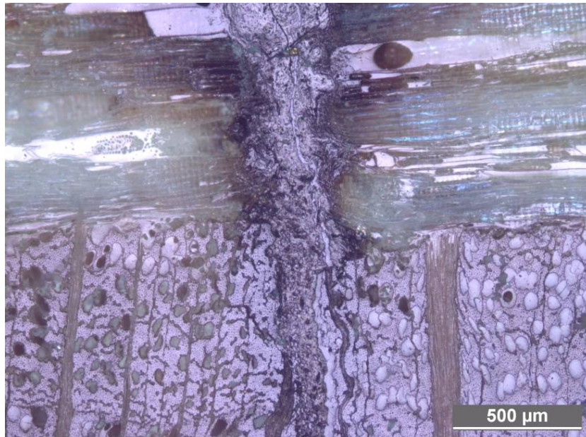
Figure 106: Observation microscopique de la ligne de soudage sur une éprouvette de CP Hêtre/Peuplier soudée sur le chant. La moitié supérieure de l'image correspond à un pli de Peuplier, la moitié inférieure à un pli de Hêtre. La ligne de soudage traverse l'image au centre de haut en bas.
