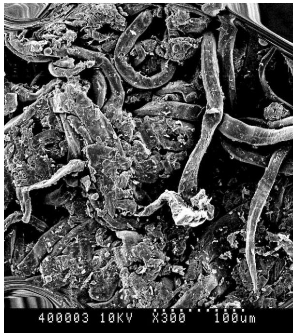
Figure 26: Image de microscopie électronique à balayage de l'interface soudée ouverte mettant en évidence l'existence d'un réseau de fibres de bois enchevêtrées et bloquées dans une matrice durcie de matériel inter-cellulaire (Gfeller et al. 2003).
