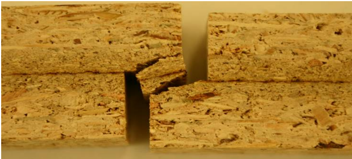
Figure 103: Mode de rupture du panneau de particules soudé sur face.
