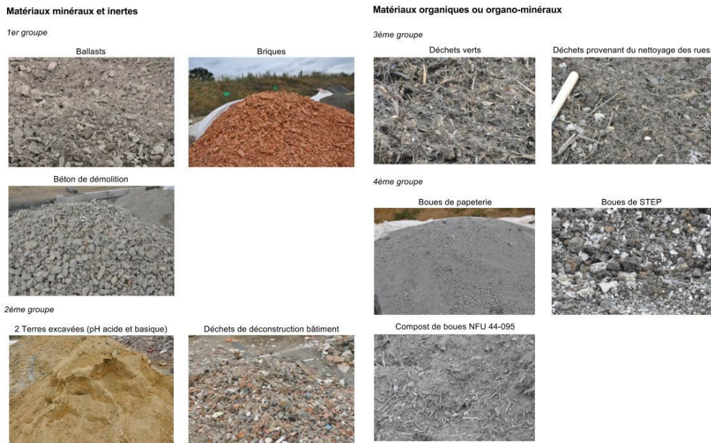
Figure 22. Grandes catégories de matériaux susceptibles d'être utilisés en construction de sol pour la végétalisation urbaine (Damas & Coulon, 2016)
