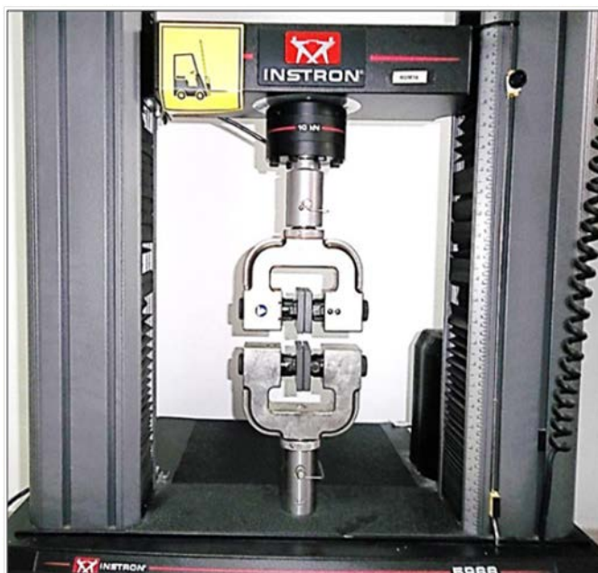
FIGURE 2.5 – Machine de traction de type INSTRON 5966 de charge maximale 10 kN équipée par des mors de serrage plats pour les fils orthodontiques lors de l'essai de traction.
