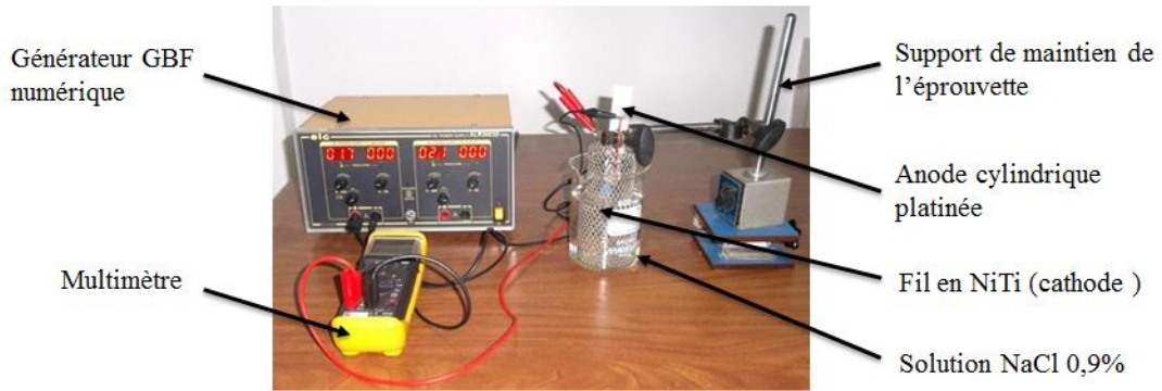
FIGURE 2.2 – Montage de chargement en hydrogène des arcs orthodontiques NiTi par voie cathodique.
