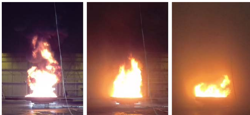
FIGURE 3.20 – Effet de l'aspersion sur le foyer lors de l'essai 10. De gauche à droite : avant aspersion ; 60 s après aspersion ; 120 s après aspersion.
