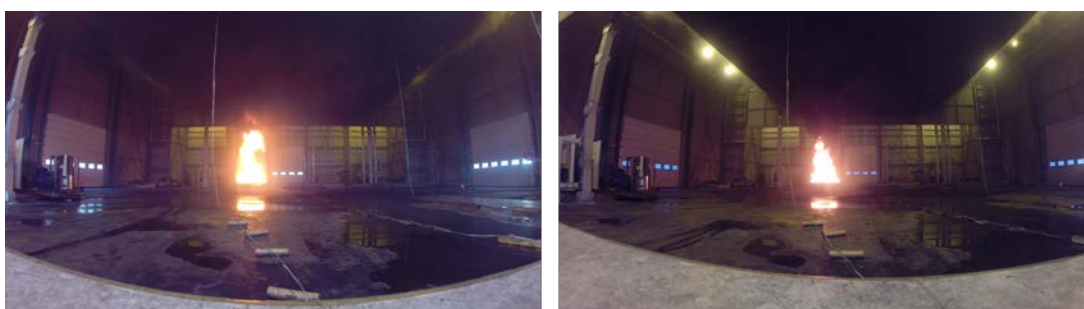
(c) 3 min après activation de l'aspersion (exutoires ouverts à droite)
