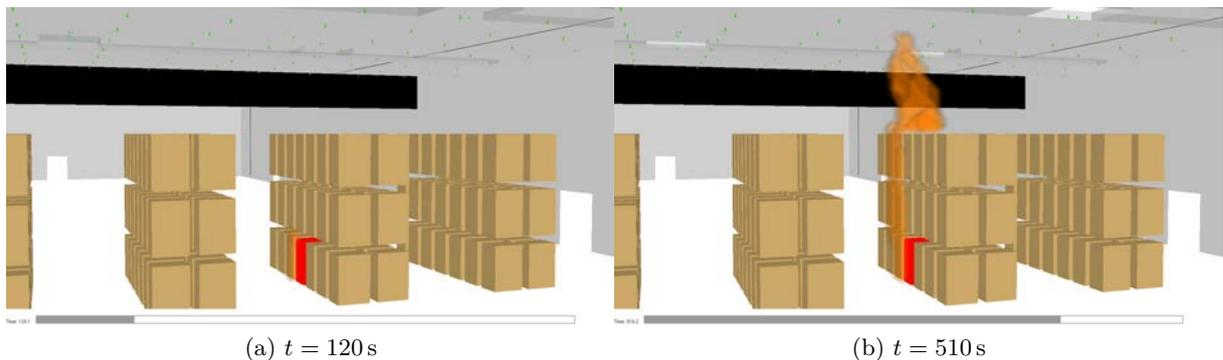
FIGURE 4.4 – Visualisation du développement du foyer dans la cellule de stockage à deux instants différents.
