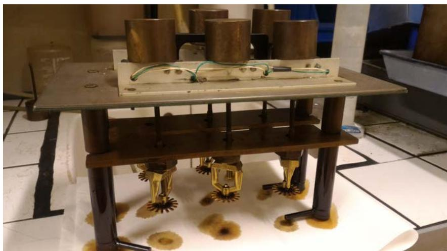
FIGURE 2.8 – Dispositif (armature + sprinkleurs) du test du bain d’huile.
