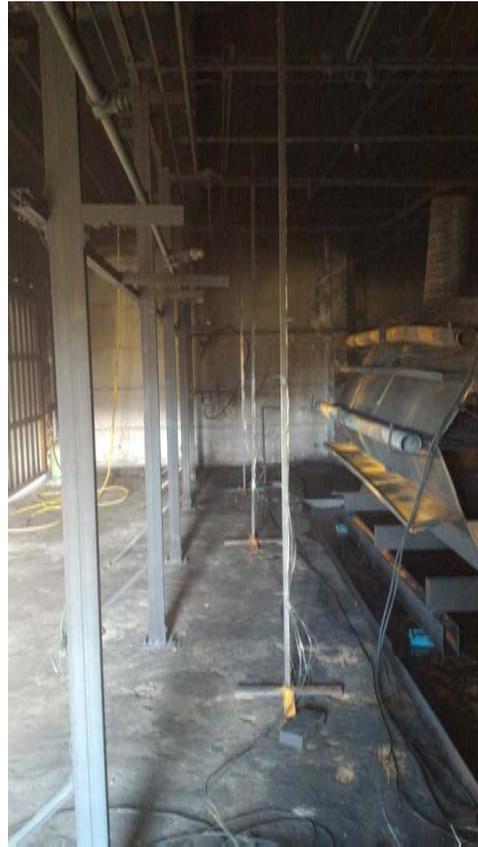
FIGURE 2.2 – Maquette de transformateur et banc de brouillard d'eau présents dans le local d'essais.
