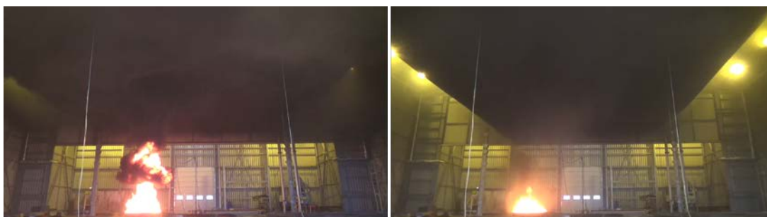
FIGURE 3.21 – Influence du sprinkleur SD10 sur le foyer de l'essai 15. À gauche : avant aspersion. À droite : quelques minutes après l'activation de l'aspersion.
