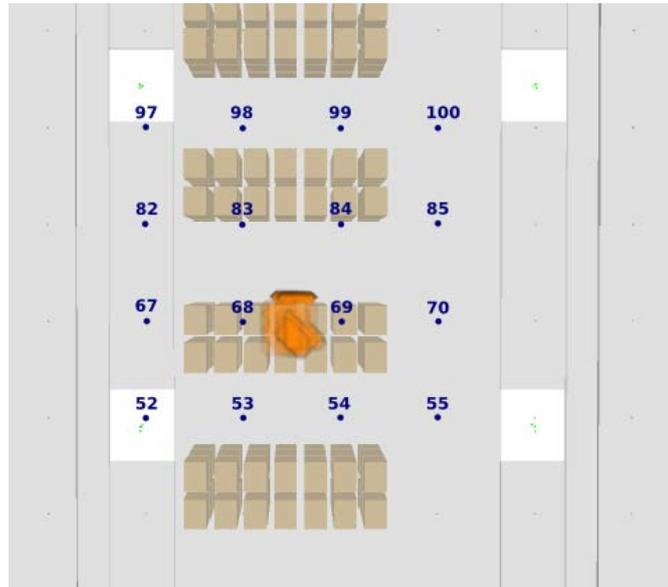
FIGURE 4.6 – Position des sprinkleurs situés au voisinage du foyer.
