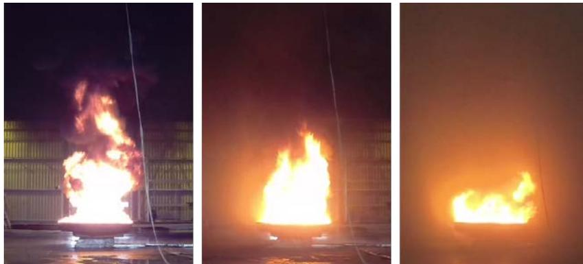
FIGURE 3.20 – Effet de l'aspersion sur le foyer lors de l'essai 10. De gauche à droite : avant aspersion ; 60 s après aspersion ; 120 s après aspersion.
