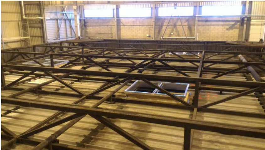
FIGURE 3.3 – Positions des trois exutoires installés sur le plafond mobile. Sur cette photo, les capots des exutoires ne sont pas présents.
