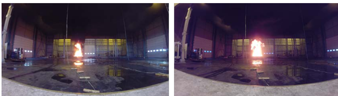
(b) Activation de l'aspersion (ouverture des exutoires à droite)
