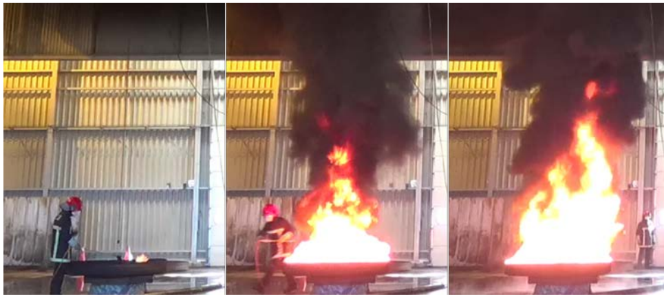
FIGURE 3.5 – Développement d'un feu de bac de fioul (essai n°18). De gauche à droite : t_0 (début de l'allumage), t_0 + 60 s (fin de l'allumage) et t_0 + 120 s.
