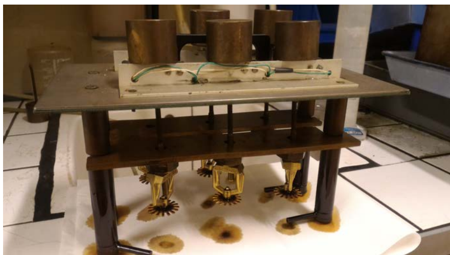
FIGURE 2.8 – Dispositif (armature + sprinkleurs) du test du bain d’huile.
