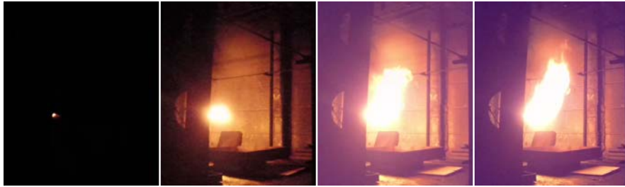
FIGURE 2.30 – Inflammation du spray de fioul (400 kW). De gauche à droite : t = 0 s (seule la flamme de propane est visible), t = 0.4 s, t = 1.2 s et t = 2 s
