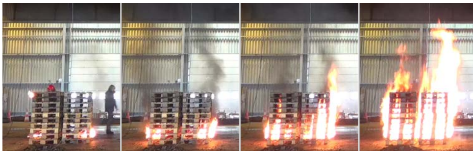
FIGURE 3.8 – Développement d'un feu de palettes (essai n°23). De gauche à droite : t_0 (fin de l'allumage), t_0 + 60 s, t_0 + 120 s et t_0 + 180 s.
