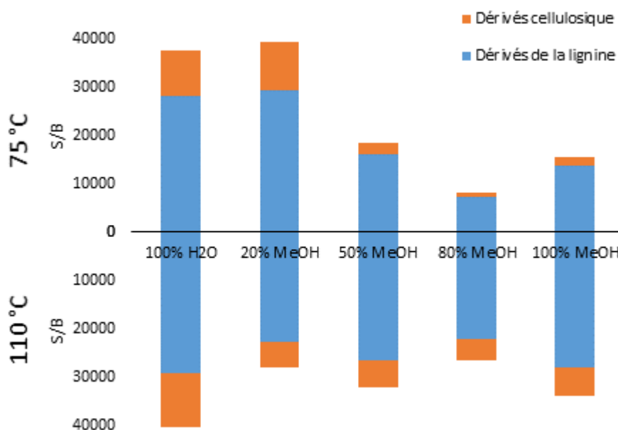
Figure 8. Distribution de la somme des rapports signal/bruit relatifs aux composés dérivés de la lignine (en bleu) et de la cellulose/hémicellulose (en orange) en fonction de la composition du solvant pour des températures de capillaire d'infusion de 75 et 110 °C.
