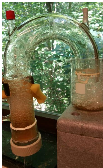
Figure 20. Système de fractionnement par bullage de CO 2 .
