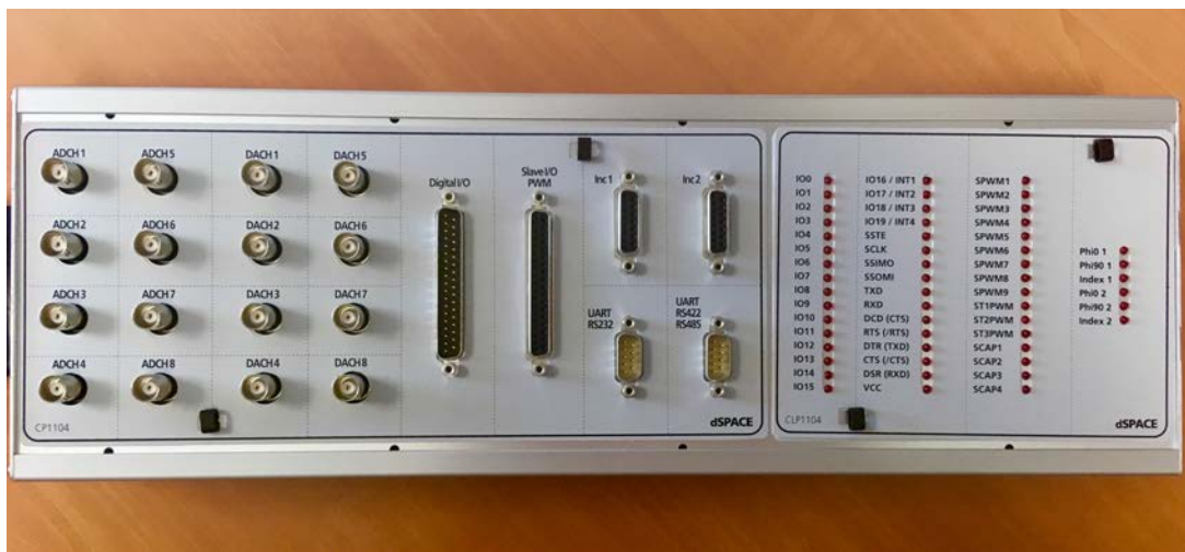
FIGURE 4.28 – Dispositif d'interface entre la carte dSPACE et le convertisseur (Control Panel).
