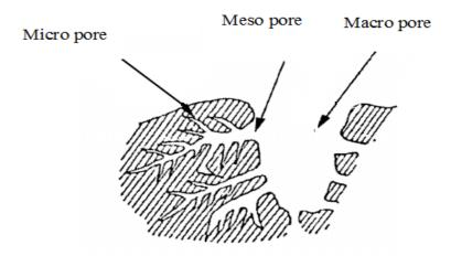
Figure 2 : La structure poreuse d'un charbon actif granulé.
