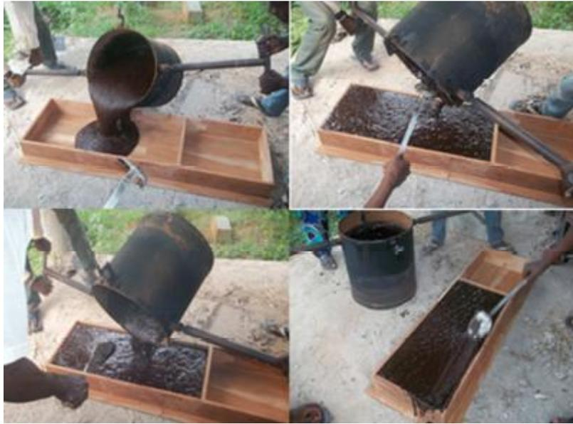
Figure 28 : Principe de moulage
