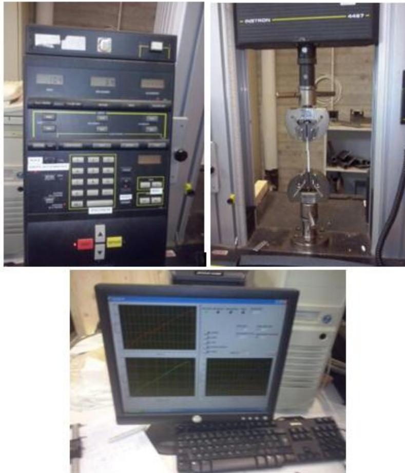
Figure 32 : Dispositif de traction marque INSTRON
