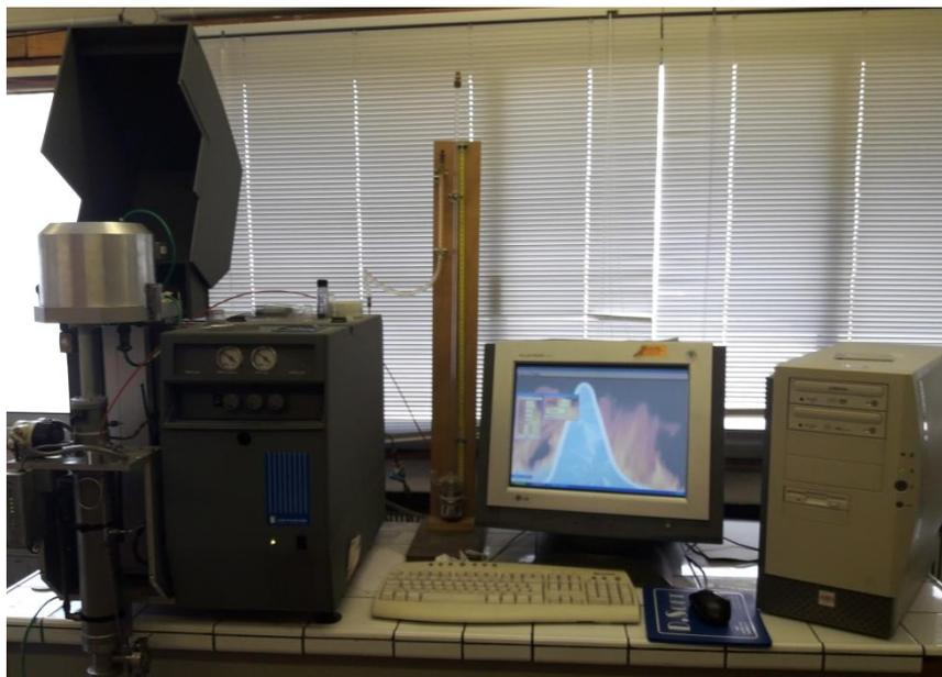
**Figure 30 : Dispositif d'ATG de marque SETRAM SETSYS**
