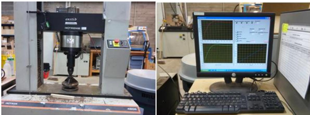
Figure 34 : Dispositif d'essai de compression
