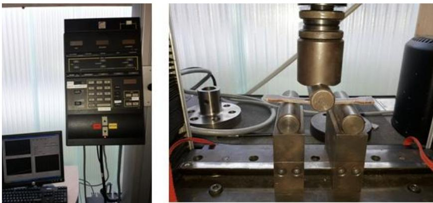
Figure 35 : dispositif d'essai de flexion
