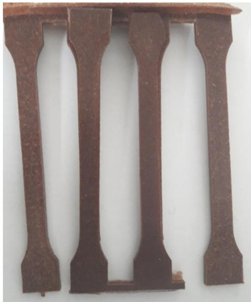
**Figure 23 : Eprouvetttes d'essais de traction**
