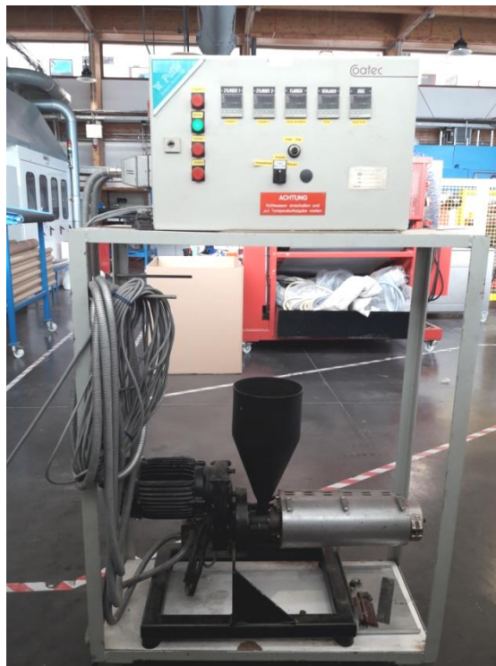
Figure 20 : Extrudeuse monovis utilisée pour la mise en forme des composites
