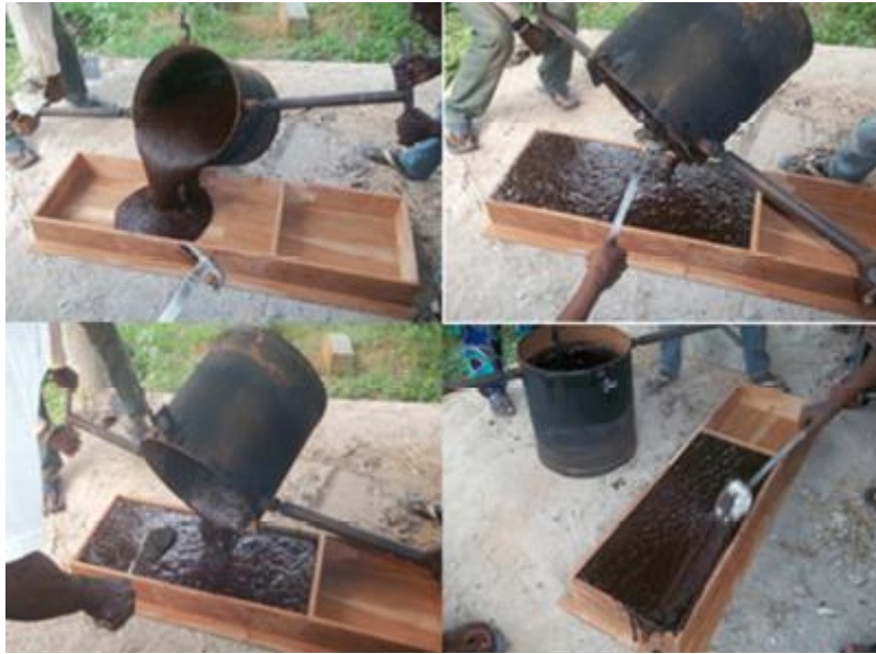
Figure 28 : Principe de moulage
