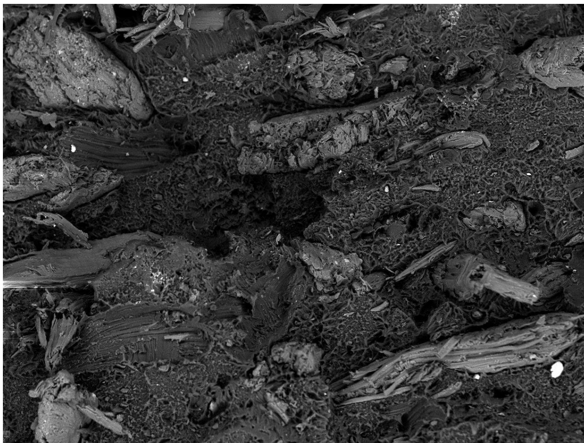
Annexe 3 : Vue au MEB du faciès de rupture du CBP à l'échelle X 100
