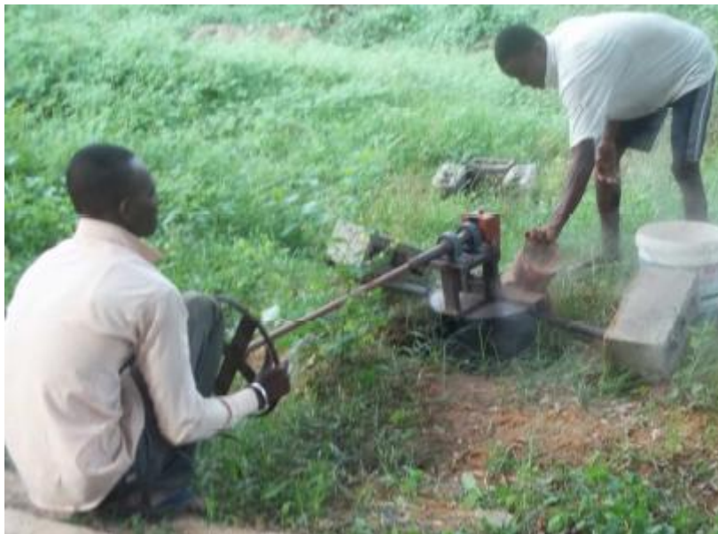
Figure 27 : Etape de mélange de la colle et de la sciure
