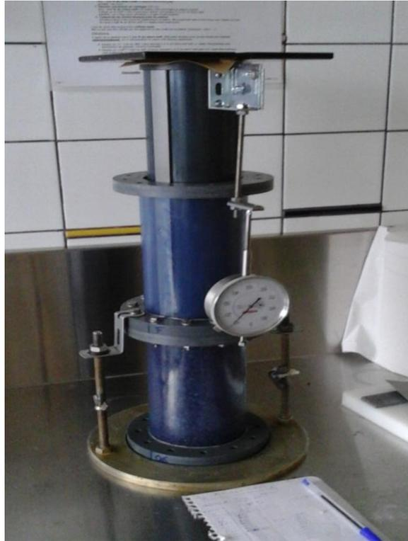
Figure 33: Dispositif d'essai œdométrique
