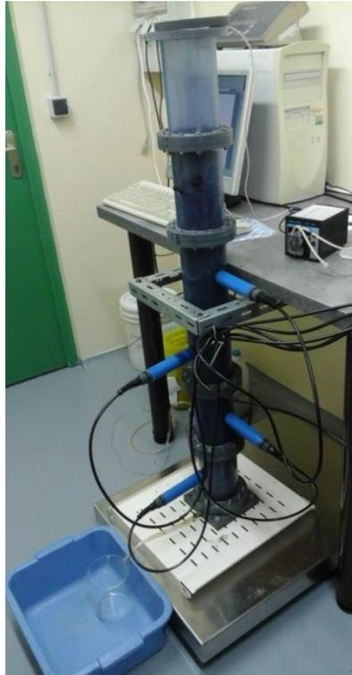
**Figure 31: Colonne métrique utilisée munie des sondes TDR**
