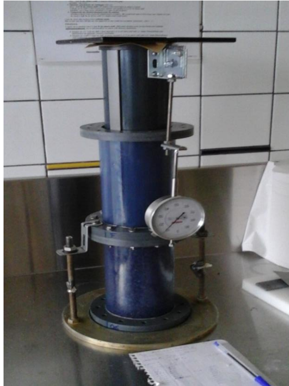
Figure 33: Dispositif d'essai œdométrique
