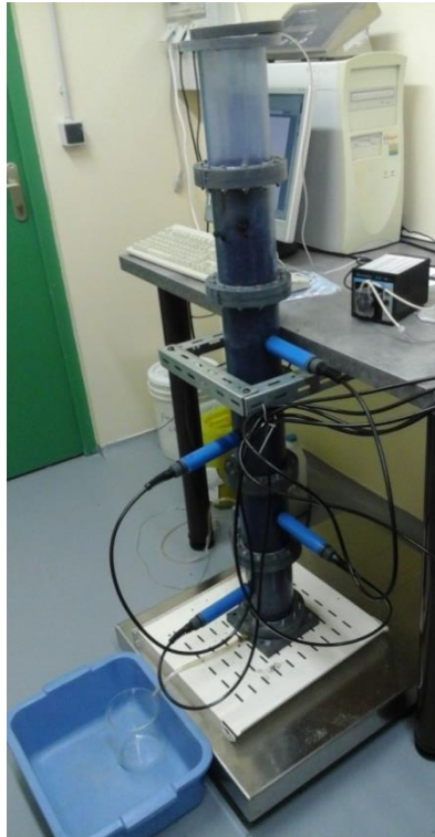
Figure 31: Colonne métrique utilisée munie des sondes TDR
