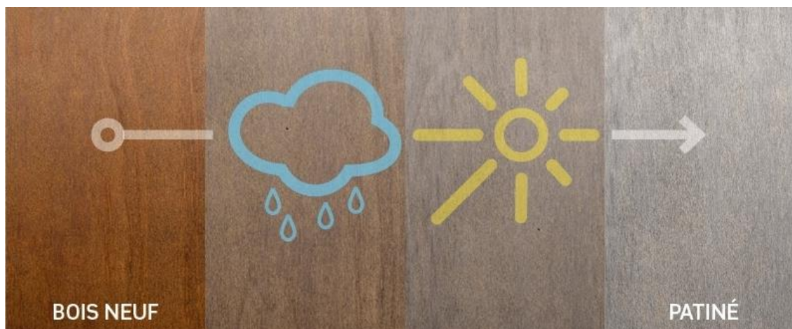
Figure 31 : Pin radiata traité par furfurylation. Evolution au cours du temps et de la météo 125
