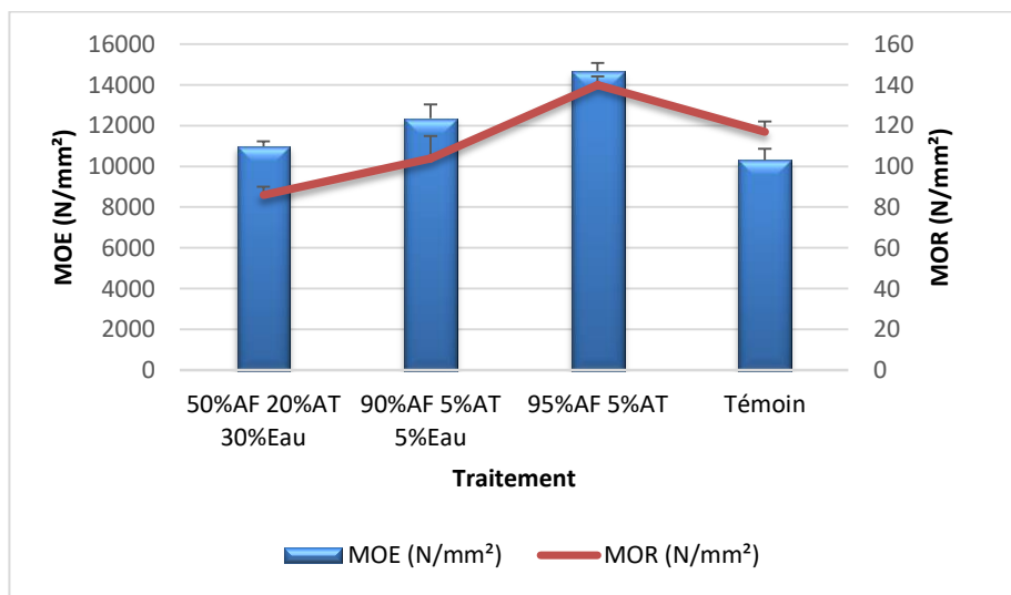
Graphe 33 : Effet de l'imprégnation de solution d'alcool furfurylique sur la mesure du MOE et du MOR
