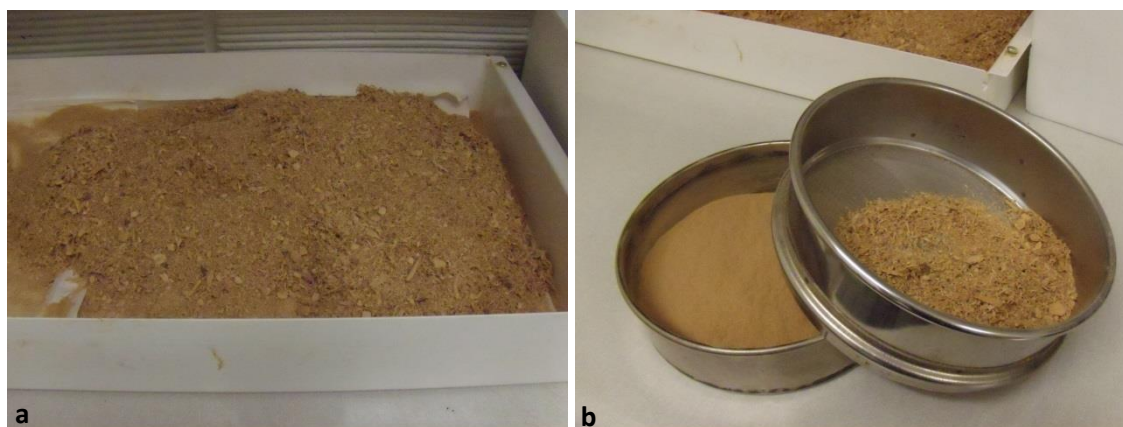
Figure 40 : a) Sciure de hêtre avant tamisage b) particules de hêtre après passage au tamis
