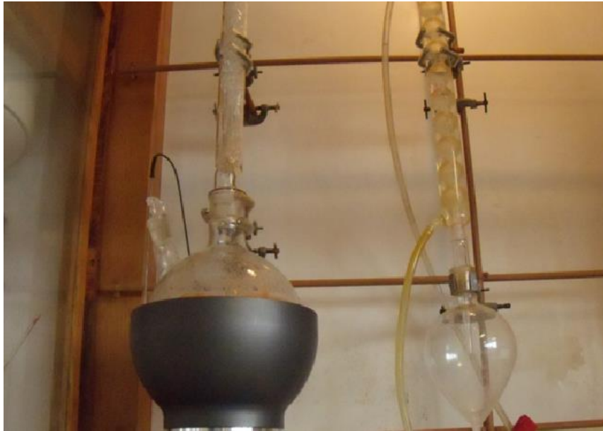
Figure 39 : Montage d'hydrodistillation utilisé pour l'hydrolyse de la sciure de hêtre
