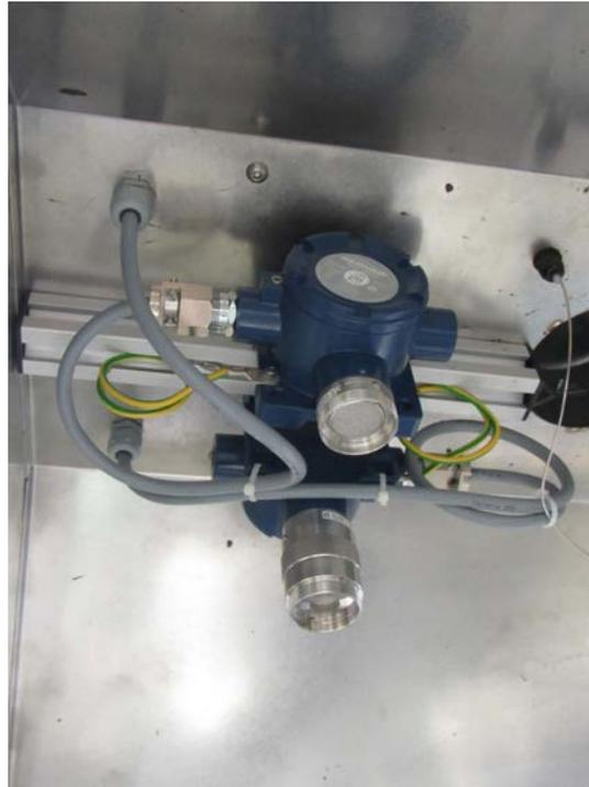
FIGURE 4.32 – Détecteurs de gaz placés dans la hotte.
