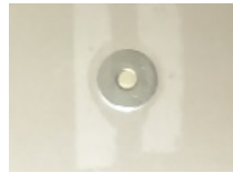
Figure 4-10 - Préparation du porte-échantillon (rondelle métallique de 1 mm d'épaisseur) avec le matériau initialement à l'état liquide en son centre.
