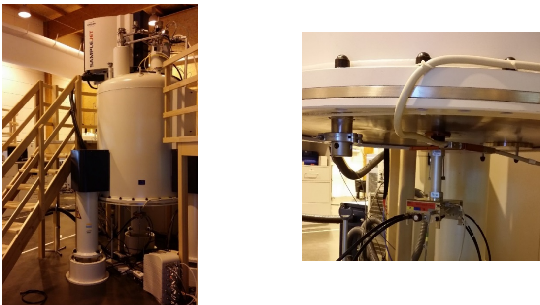
Figure 2-12 - A gauche, spectromètre RMN solide 800 MHz du CRMN de Lyon. A droite, sonde MAS (pour « Magic Angle Spinning ») ^1\text{H}/^{13}\text{C}/^{15}\text{N} du spectromètre.
