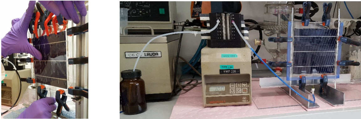
Figure 4-3 - A gauche, photo illustrant l'insertion de l'aiguille de remplissage à travers le joint pour atteindre l'intérieur du module PV. A droite, système de remplissage (au centre de l'image se trouve la pompe péristaltique).
