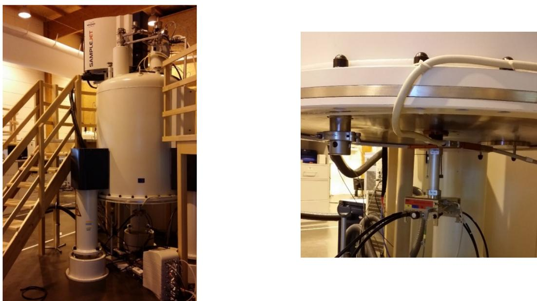
**Figure 2-12** - A gauche, spectromètre RMN solide 800 MHz du CRMN de Lyon. A droite, sonde MAS (pour « Magic Angle Spinning »)  $^1\text{H}/^{13}\text{C}/^{15}\text{N}$  du spectromètre.
