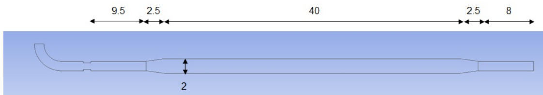
Figure II.3.7 – Coupe schématique de la cellule étudiée avec coude et embout. Les dimensions sont données en centimètre.
