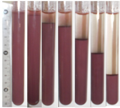
Figure I.1.15 – Évolution du front de sédimentation en fonction du temps dans un tube à essai, pour une suspension composée de 12% de particules d'hématite et une solution de soude concentrée à 50% en masse à température ambiante.
