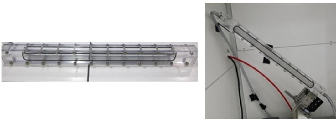
Figure II.2.1 – Cellule d'écoulement de 45 cm de longueur.
