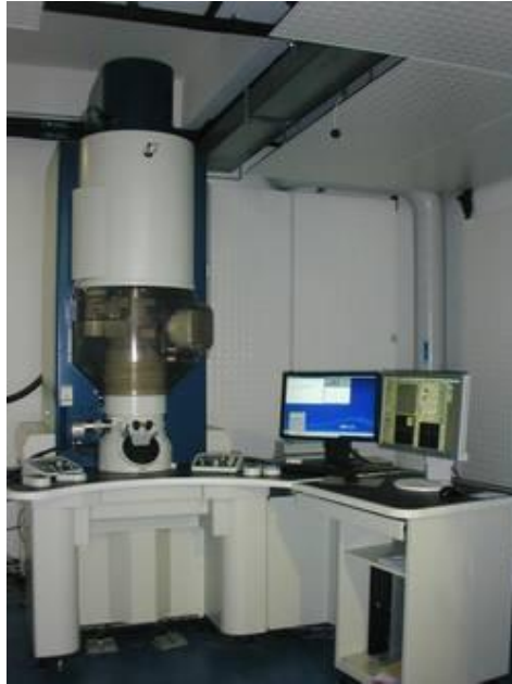
Fig II.7 : Vue générale du microscope en transmission de haute résolution ARM200F.
