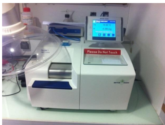
Figure 106. ATG DSC (appareil couplant analyse thermogravimétrique et calorimétrie différentielle à balayage)
