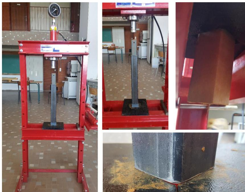
Figure 20 : dispositif de moulage et démoulage
