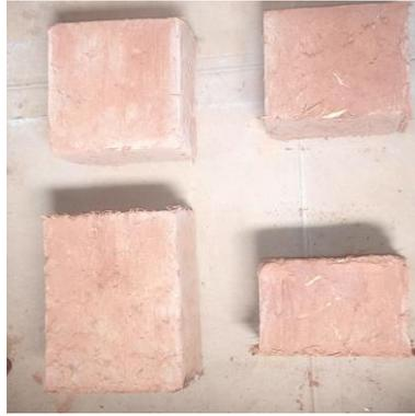
Figure 54 : échantillons de différentes épaisseurs testés
