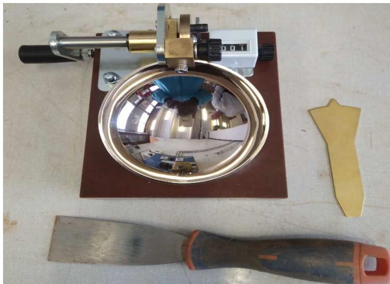
Figure 3-6 : Coupelle de Casagrande
