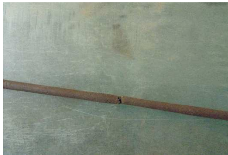
Figure 3-10 : Préparation d'un rouleau pour l'essai de plasticité.
