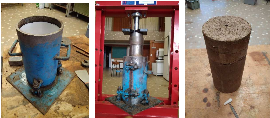
Figure 3-21: Fabrication des éprouvettes
