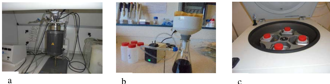
Figure 3-17 : (a : Reacteur à Batch, b : Opération de filtration, c : Centrifugeuse)
