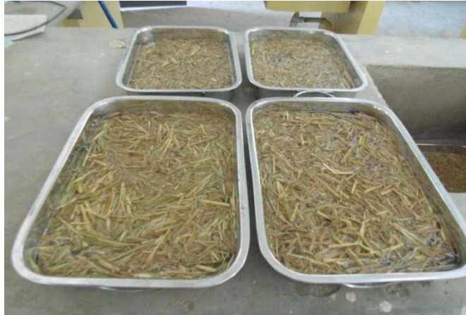
Figure 3-29 : Paille de riz imprégnée dans l'eau
