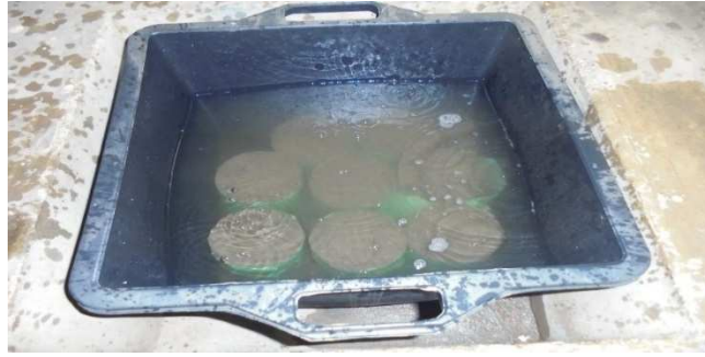
Figure 3-45 : Eprouvettes cylindriques en mélange d'argile - gomme arabique immergées dans
