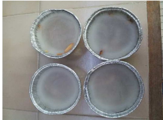
Figure 3-14 : Paille de riz imprégnée dans l'huile de paraffine
