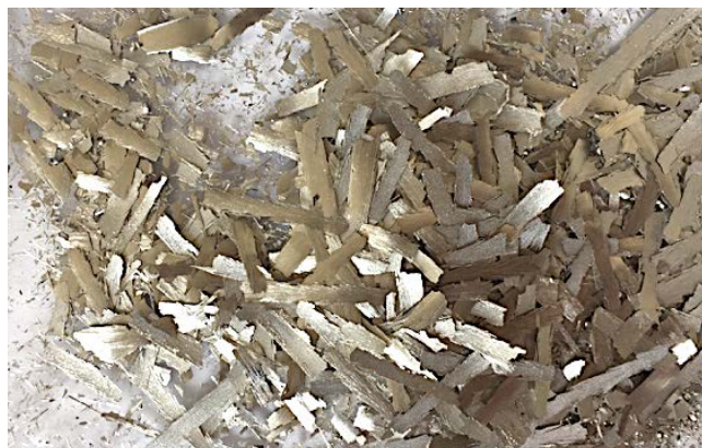
Figure III. 22. Photographie des rubans Sn-Te formés par la technique MS.
