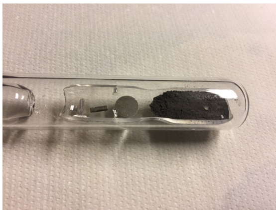
Figure III. 16. Photographie de l'ensemble nacelle - ampoule contenant les échantillons SnTe avec la source avant le recuit de saturation.
