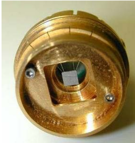
Figure IV. 6. Porte échantillon utilisé pour les mesures de chaleur spécifique.
