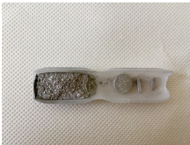
Figure III. 18. Photographie d'une nacelle de quartz contenant les échantillons SnTe avec la source après le recuit de saturation.
