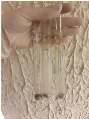
Figure III. 8. Photographie des ampoules en quartz scellées après synthèse.
