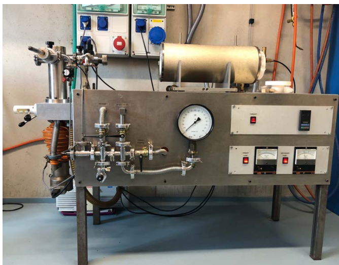
Figure III. 5. Photographie du système de pompage secondaire à diffusion d'huile.
