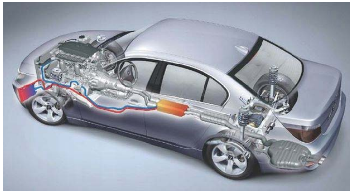
Figure I. 16. Conception d'un générateur thermoélectrique produisant de l'électricité à partir de la chaleur perdue au niveau du pot d'échappement d'un véhicule (source BMW).
