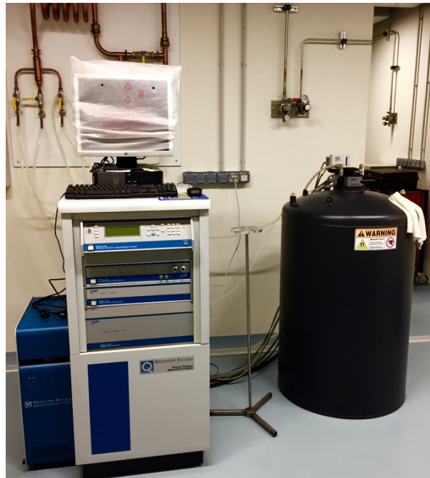
Figure IV. 7. Photographie du dispositif PPMS Quantum Design utilisé à l'IJL.
