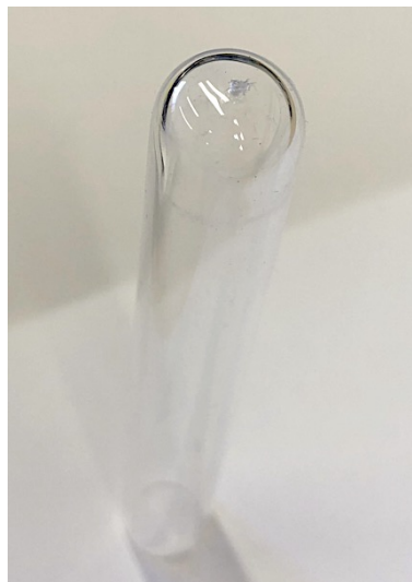
Figure III. 21. Photographie d'un tube en quartz avec une extrémité en forme de V et percé à sa pointe d'un orifice circulaire.
