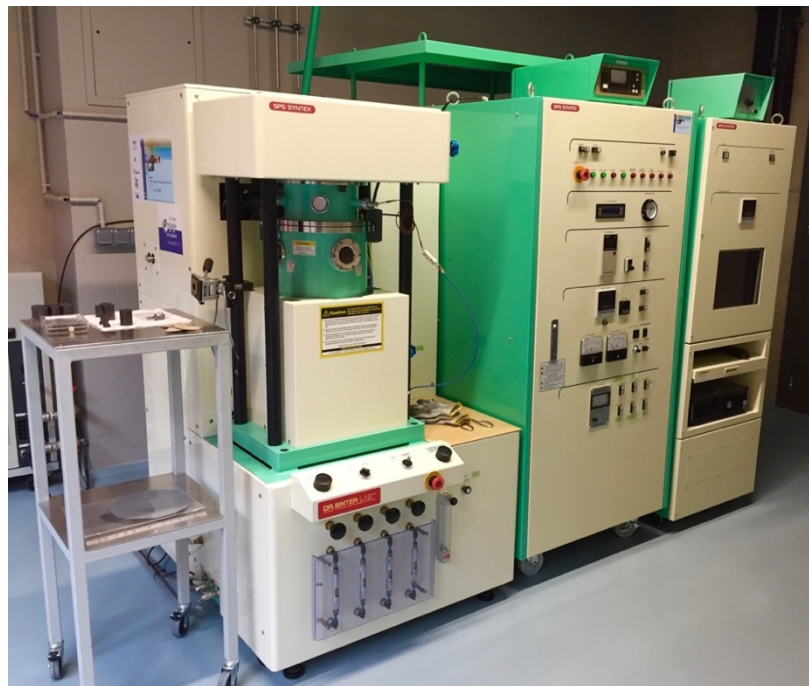
Figure III. 13. SPS Dr Sinter 515S de SPS Syntex Inc. installé à l'IJL.
