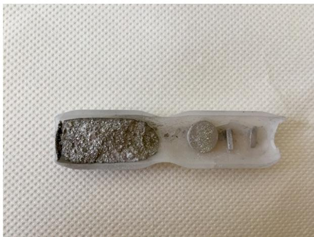
*Figure III. 18. Photographie d'une nacelle de quartz contenant les échantillons SnTe avec la source après le recuit de saturation.*
