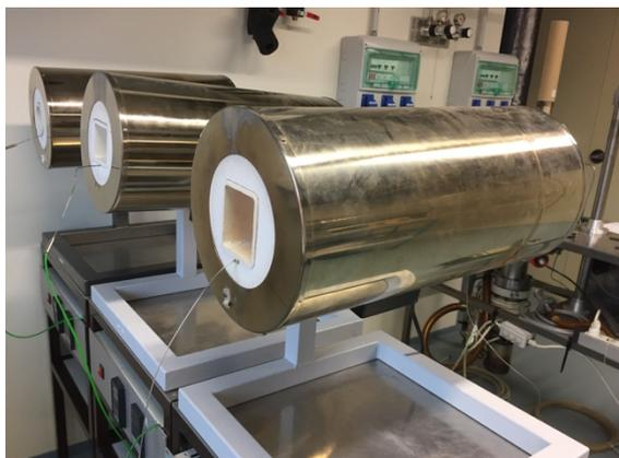
*Figure III. 17. Photographie du four horizontal.*
