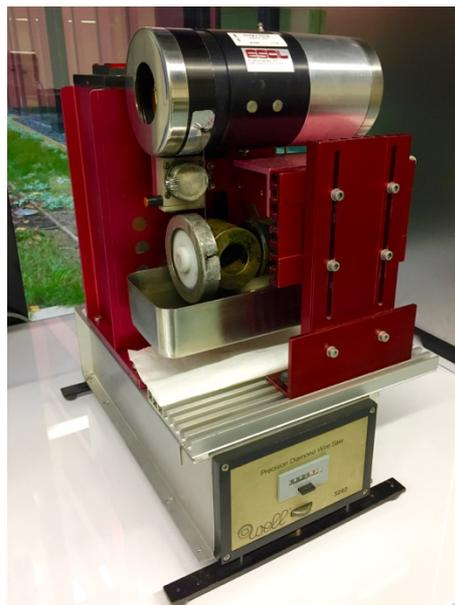
**Figure IV. 3. Photographie d'une scie à fil diamanté.**
