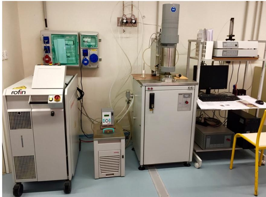
Figure IV. 14. Dispositif LFA 427 (Netzsch) de l'équipe.
