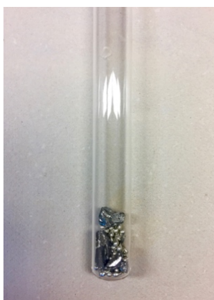
Figure III. 6 Photographie d'une ampoule en quartz contenant les granules.
