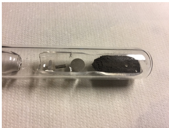
Figure III. 16. Photographie de l'ensemble nacelle - ampoule contenant les échantillons SnTe avec la source avant le recuit de saturation.
