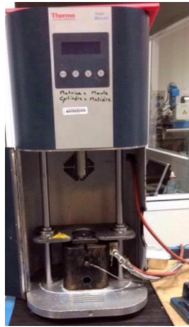
Figure 69 : MiniJet Thermohaake Rheomex utilisé pour l'injection (Photo : Marion Peyrouse)
