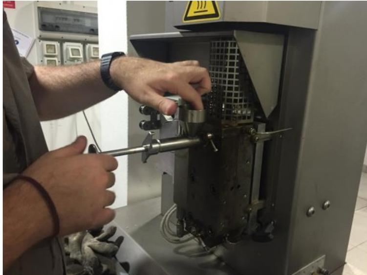
*Figure 66 : Injection des granulés dans le compounder*
