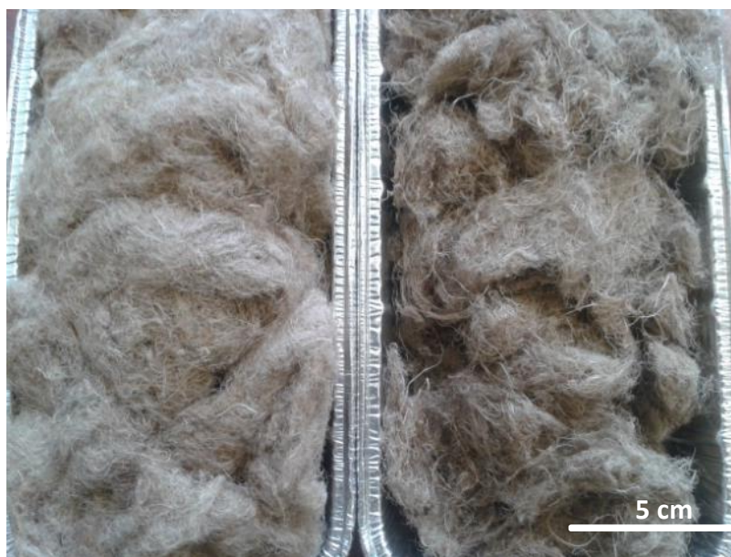
Figure 113 : Fibres obtenues après explosion à la vapeur et cardage à 33,6 % d'humidité (gauche) et 5,7 % d'humidité (droite). Les fibres sont d'une qualité sensiblement supérieure dans le cas d'un cardage à H = 33,6 \%
