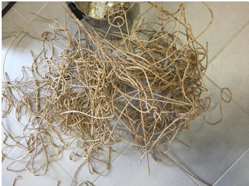
*Figure 65 : Jonc de matériau composite formé par extrusion*
