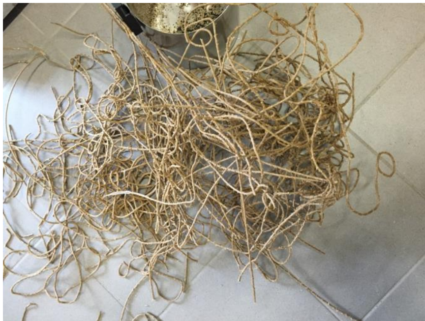
Figure 65 : Jonc de matériau composite formé par extrusion
