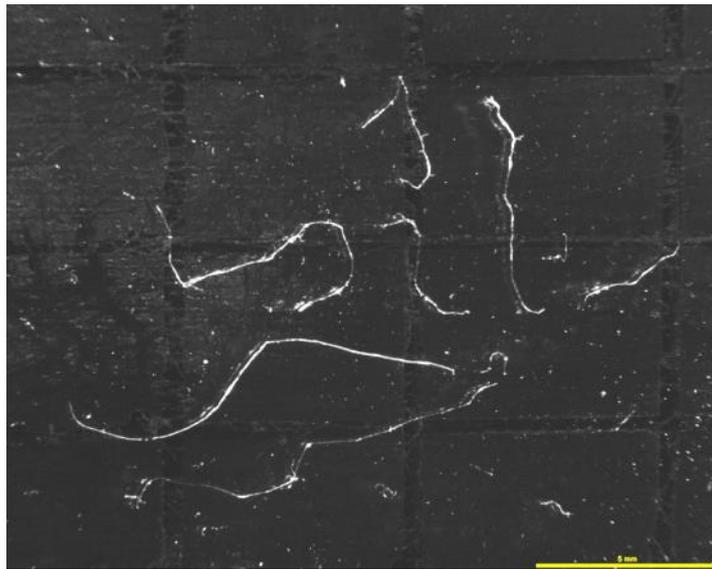
*Figure 55 : Exemple de photo (fibres non traitées) prise au microscope optique en vue de mesurer les longueurs de fibres*
