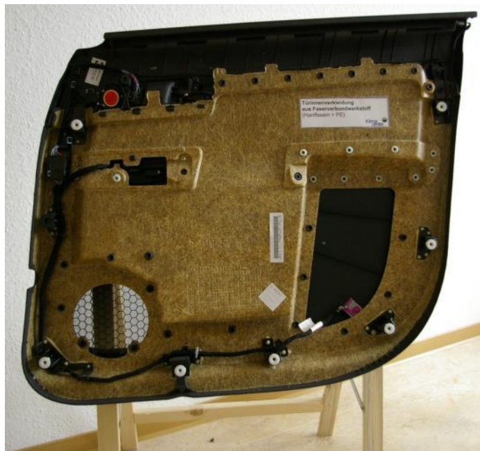
Figure 31 : Composite polyéthylène-chanvre, secteur automobile (Photo : Christian Gahle)
