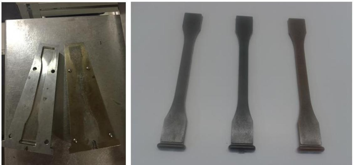
*Figure 67 : Moule et éprouvettes formées*
