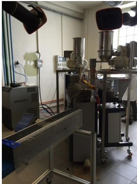
Figure 63 : Extrudeuse bi-vis Thermo Fisher Scientific utilisée pour le compoundage
