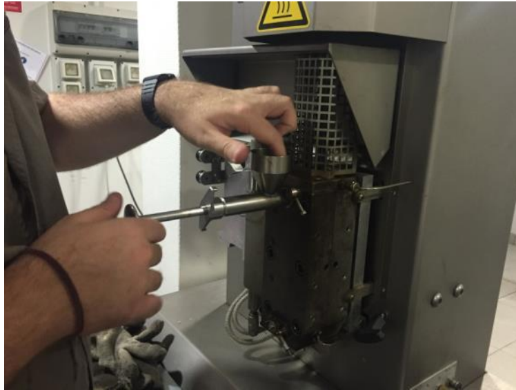
Figure 66 : Injection des granulés dans le compounder
