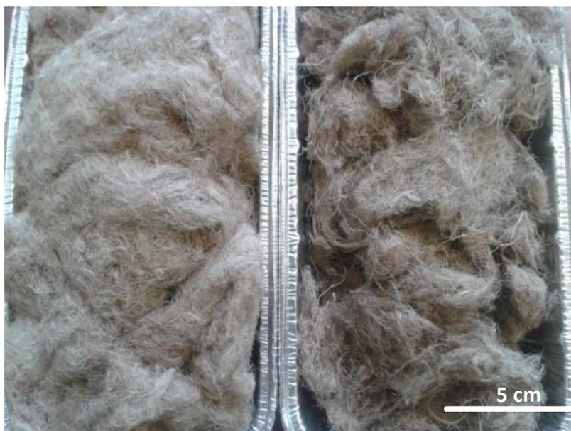
*Figure 113 : Fibres obtenues après explosion à la vapeur et cardage à 33,6 % d'humidité (gauche) et 5,7 % d'humidité (droite). Les fibres sont d'une qualité sensiblement supérieure dans le cas d'un cardage à  $H = 33,6 \%$*
