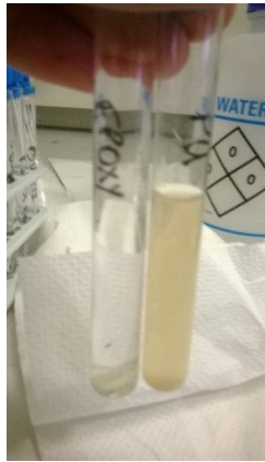
Figure 43: Photo des colles Epoxy (à gauche) et polyuréthane (à droite) après vieillissement
