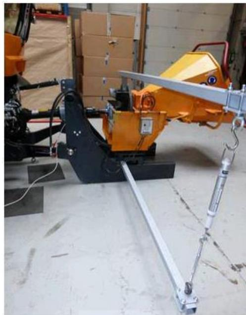
**Figure 90 : Dispositif d'étalonnage du cardan instrumenté**
