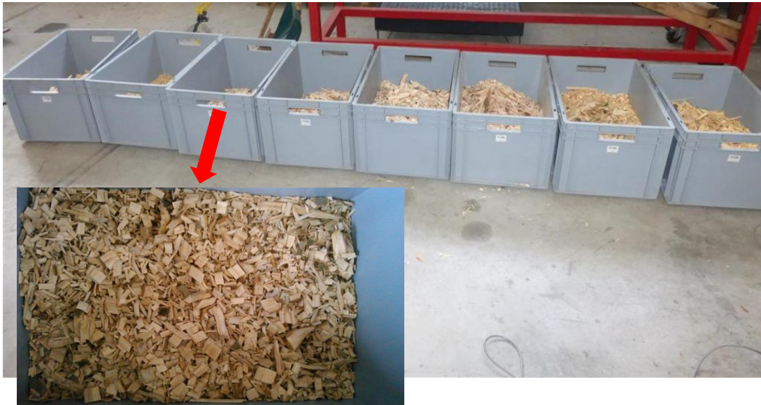
Figure 30 : Plaquettes récupérées lors du déchiquetage de 8 rondins
