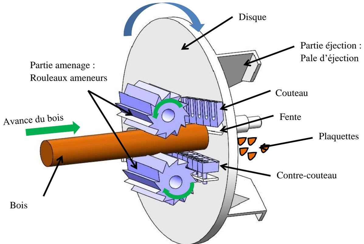
Figure 12 : Déchiqueteuse à disque [Labbé, 2017]
