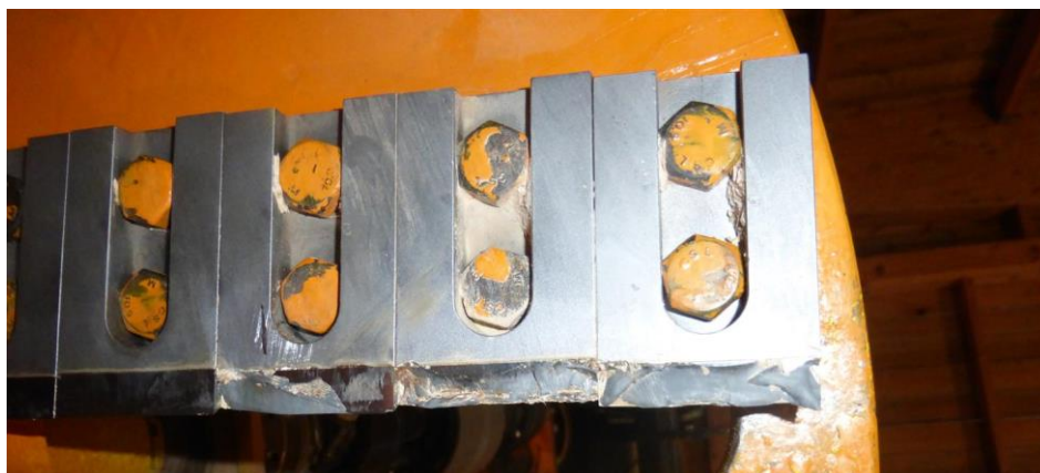
Figure 98 : Casse des couteaux lors du déchiquetage du hêtre
