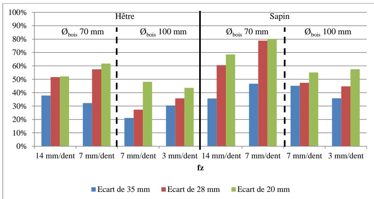
**Figure 87 : Evolution du rapport énergie de coupe sur énergie nette en fonction de la hauteur du contre couteau**
