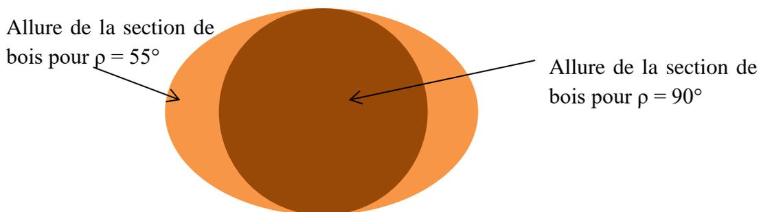
**Figure 66 : Superposition de la section du rondin pour des angles d'aménagement de 55° et 90° lors de la coupe**
