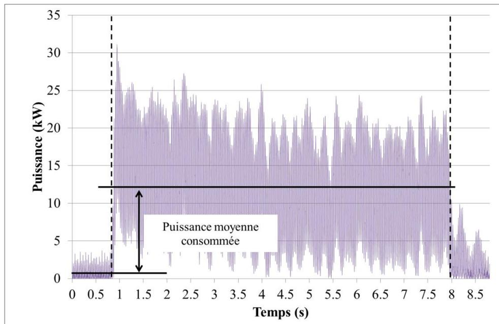
**Figure 75 : Détermination de la puissance moyenne consommée lors d'un essai de déchiquetage d'un rondin**
