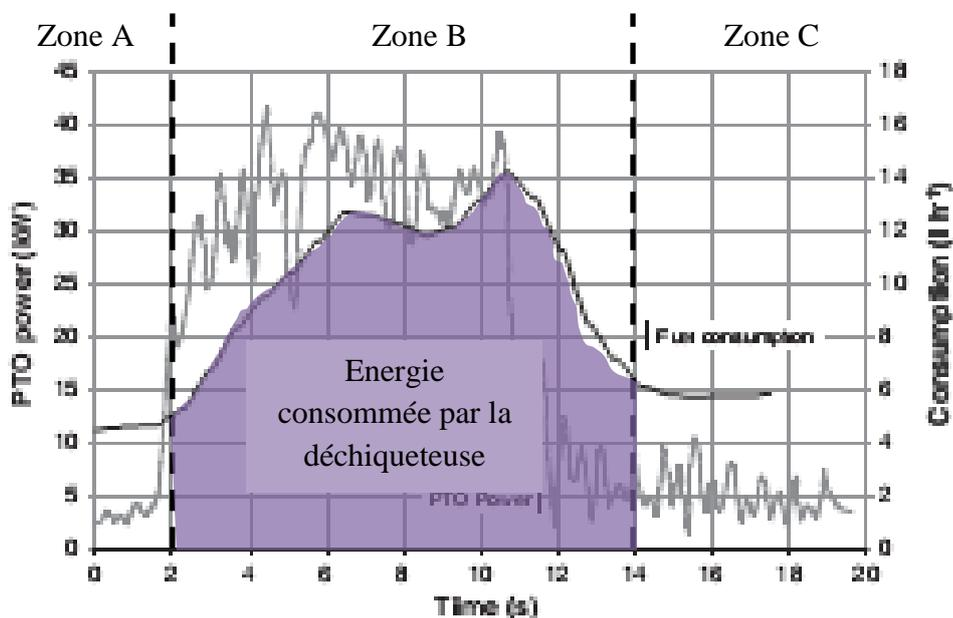
Figure 26 : Mesure de puissance et consommation de carburant lors d'un essai de déchiquetage [Spinelli, 2012a]
