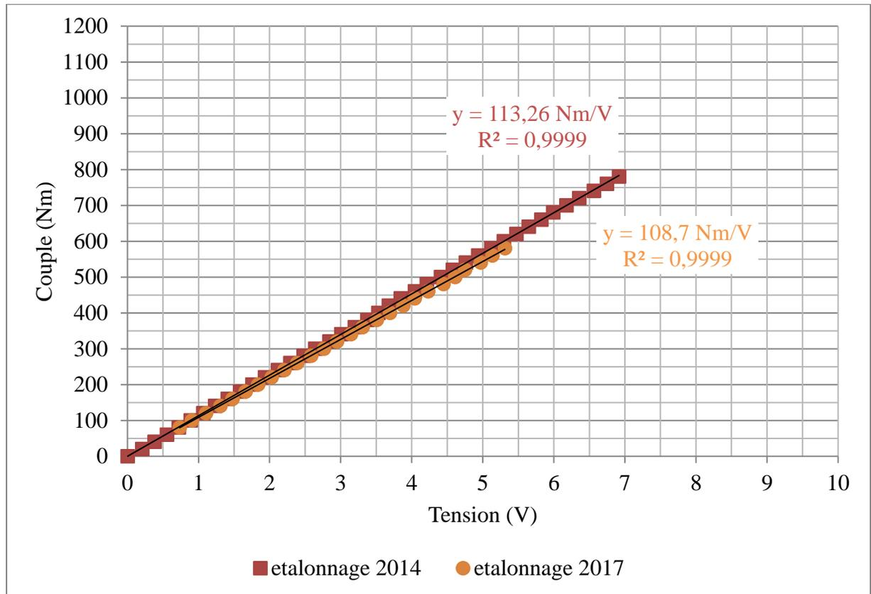
**Figure 91 : Sensibilité du cardan instrumenté**
