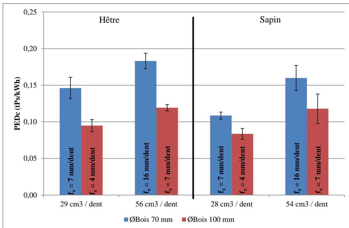
**Figure 85 : Evolution de la PEDc selon le diamètre du bois et l'avance par dent**
