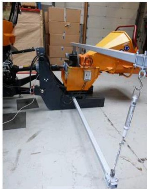
Figure 90 : Dispositif d'étalonnage du cardan instrumenté
