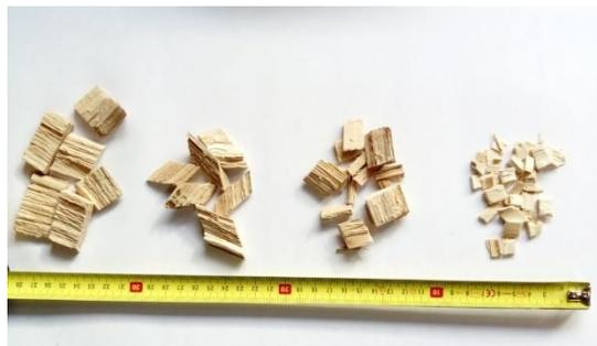
**Figure 2 : Plaquettes de bois obtenues par déchetage (Source : SL)**
