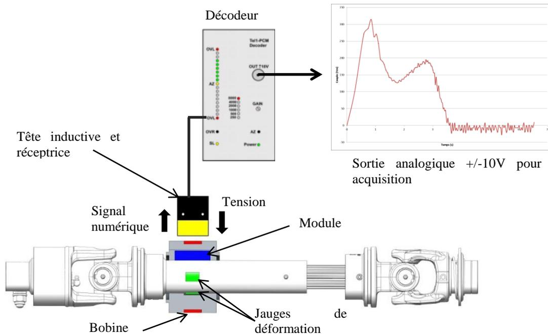
**Figure 89 : Principe de fonctionnement du cardan instrumenté**
