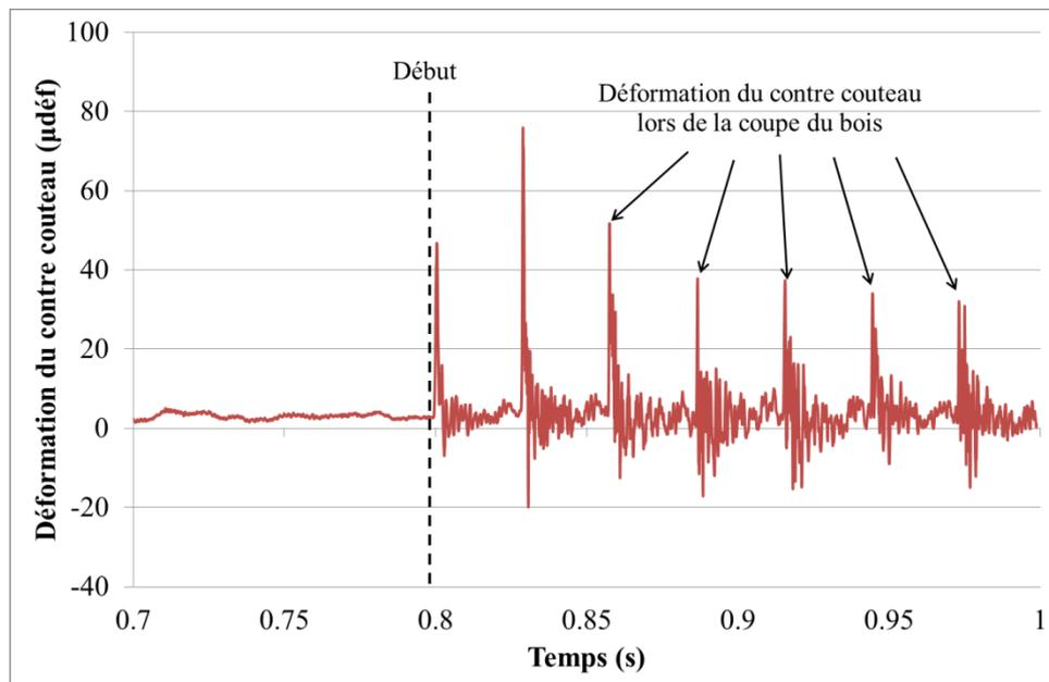
b. Mesure détaillée de la déformation au niveau du contre couteau
