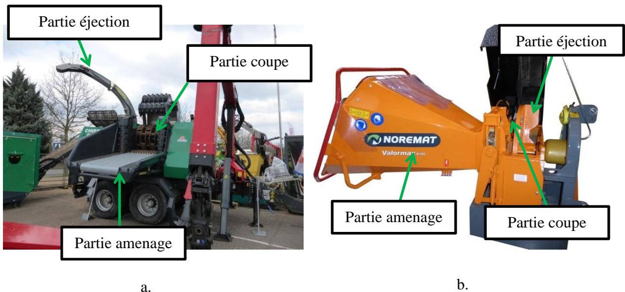
**Figure 9 : Les trois parties fonctionnelles d'une déchiqueteuse à rotor (a). et d'une déchiqueteuse à disque (b) (Source : SL)**
