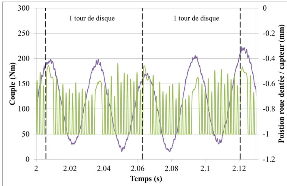
**Figure 54 : Superposition de la mesure du couple et du codeur**
