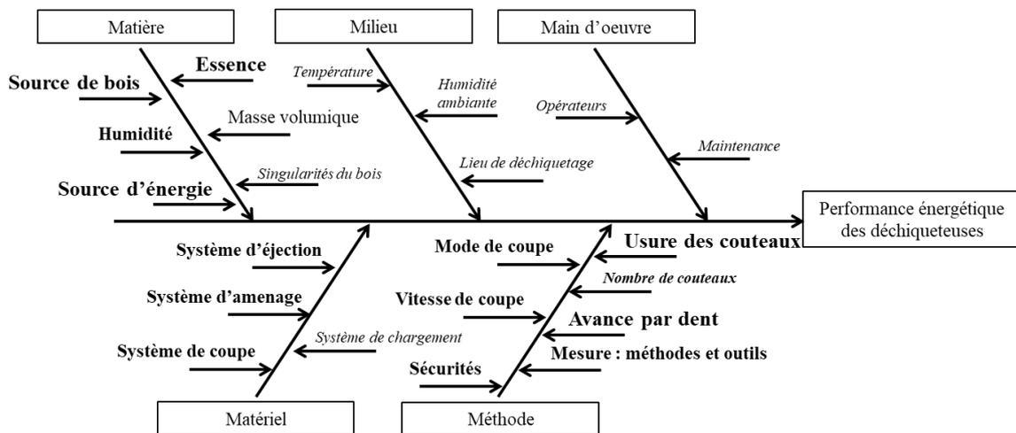
**Figure 59 : Diagramme de causes et effets**
