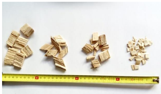
Figure 2 : Plaquettes de bois obtenues par déchiquetage (Source : SL)
