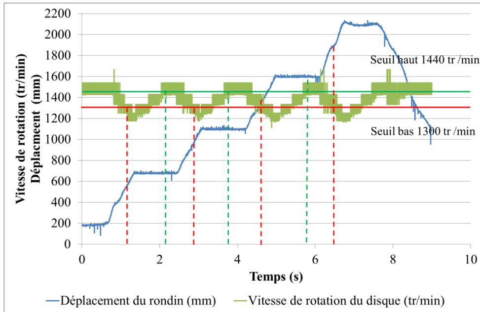
**Figure 56 : Variation de la vitesse de rotation du disque pour une puissance nécessaire importante**
