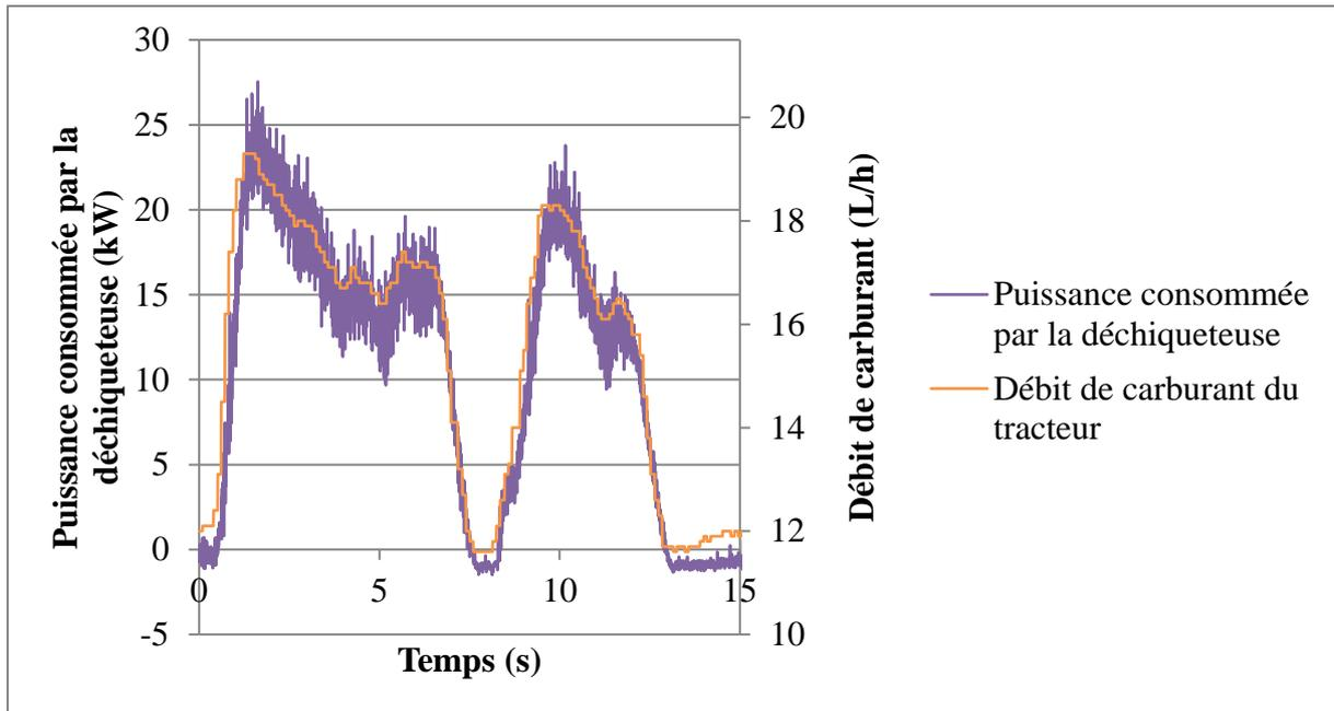
**Figure 88 : Comparaison entre le débit de carburant du tracteur et la puissance consommée de la déchiqueteuse**
