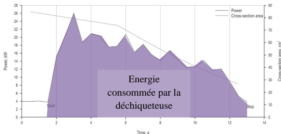
Figure 27 : Evolution de la puissance électrique fournie au moteur [Di Fulvio, 2015]
