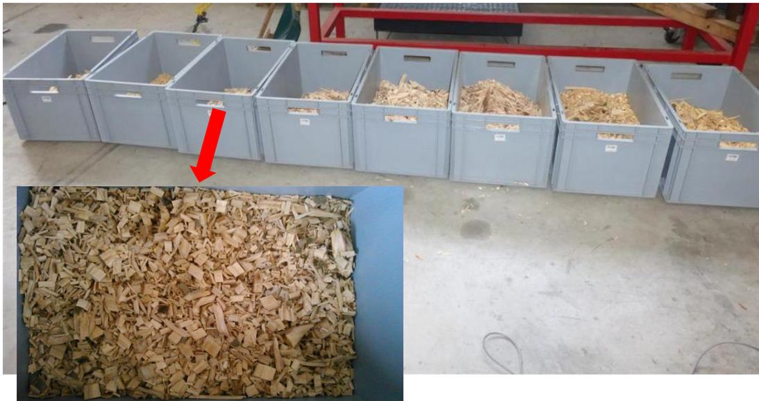
**Figure 30 : Plaquettes récupérées lors du déchiquetage de 8 rondins**
