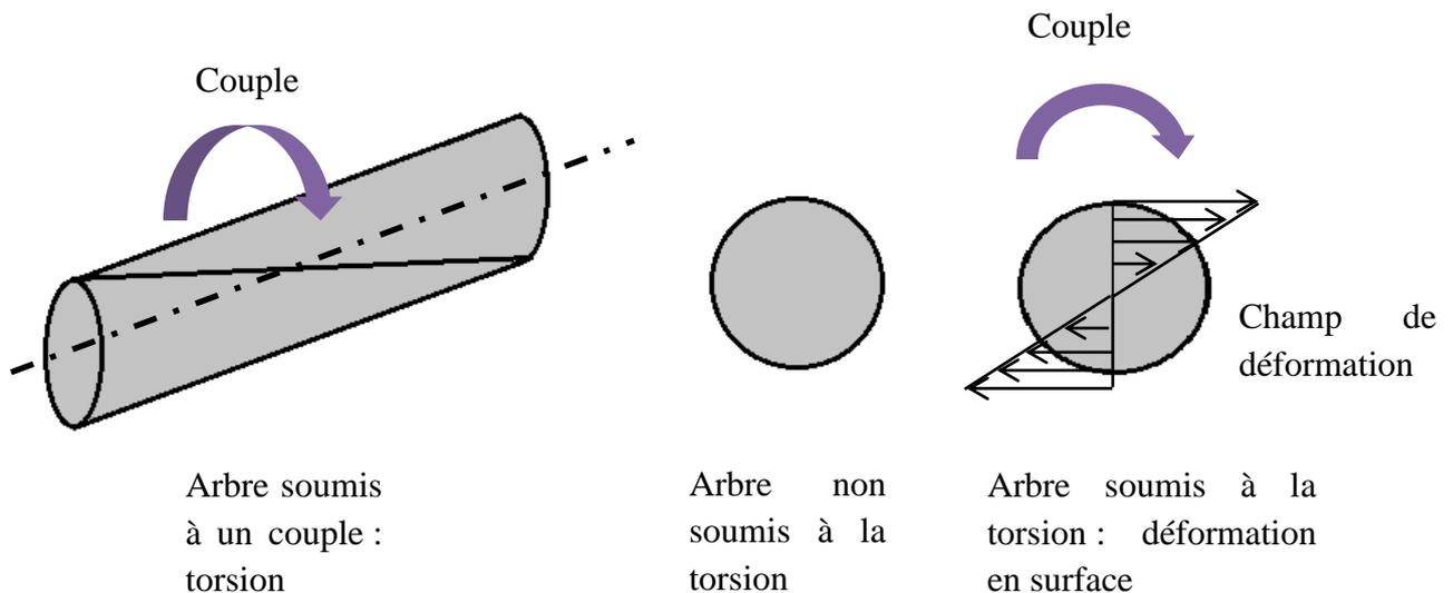
**Figure 38 : Principe de torsion d'un arbre**
