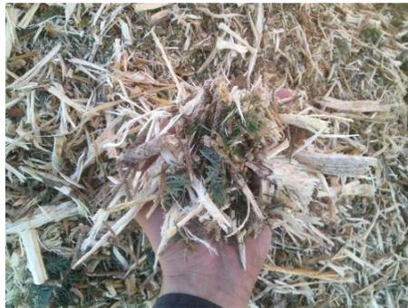
**Figure 1 : Fibres de bois obtenues par défibrage (Source : SL)**
