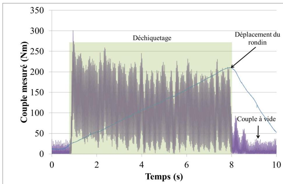
**Figure 53 : Exemple de la mesure du couple au cours d'un essai de déchiquetage.**
