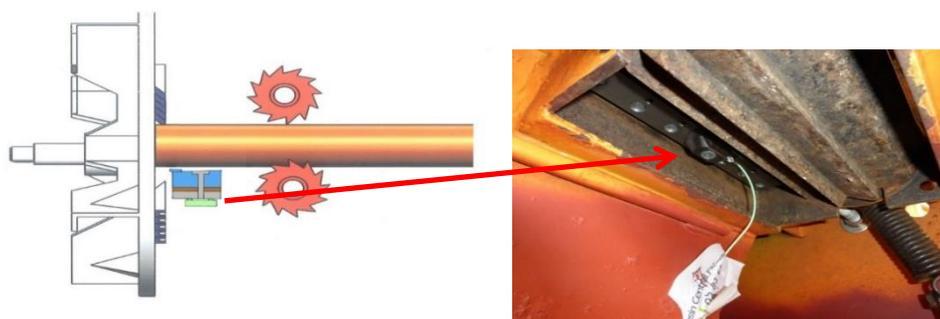
**Figure 35 : Dispositif de mesure de l'effort de coupe par la mesure de la déformation du contre-couteau**
