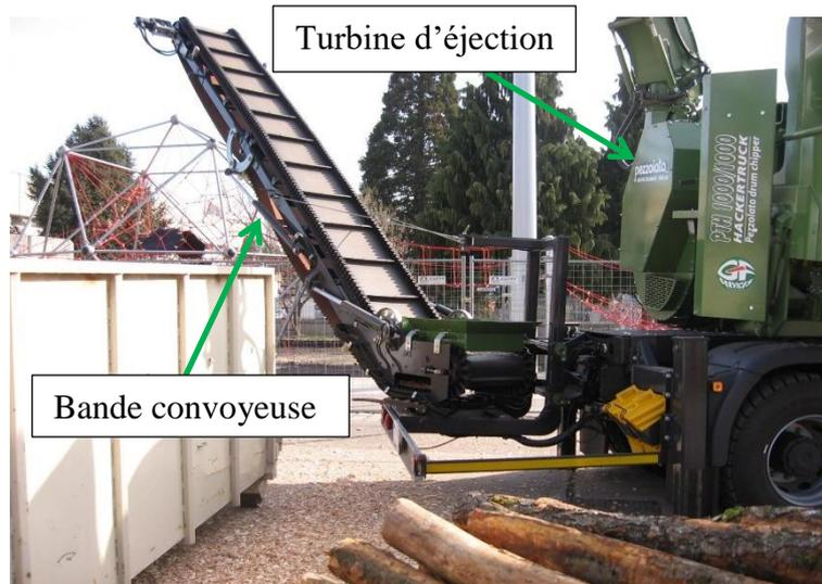
**Figure 15 : Exemple des deux systèmes d'éjection (source : SL)**
