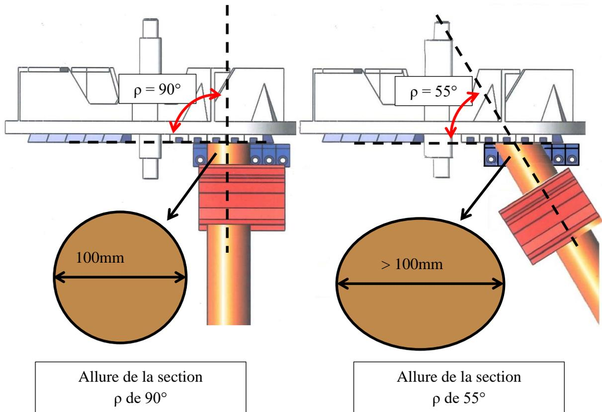
**Figure 36 : Modification de l'angle d'amenage des rondins sur la déchiqueteuse B160**
