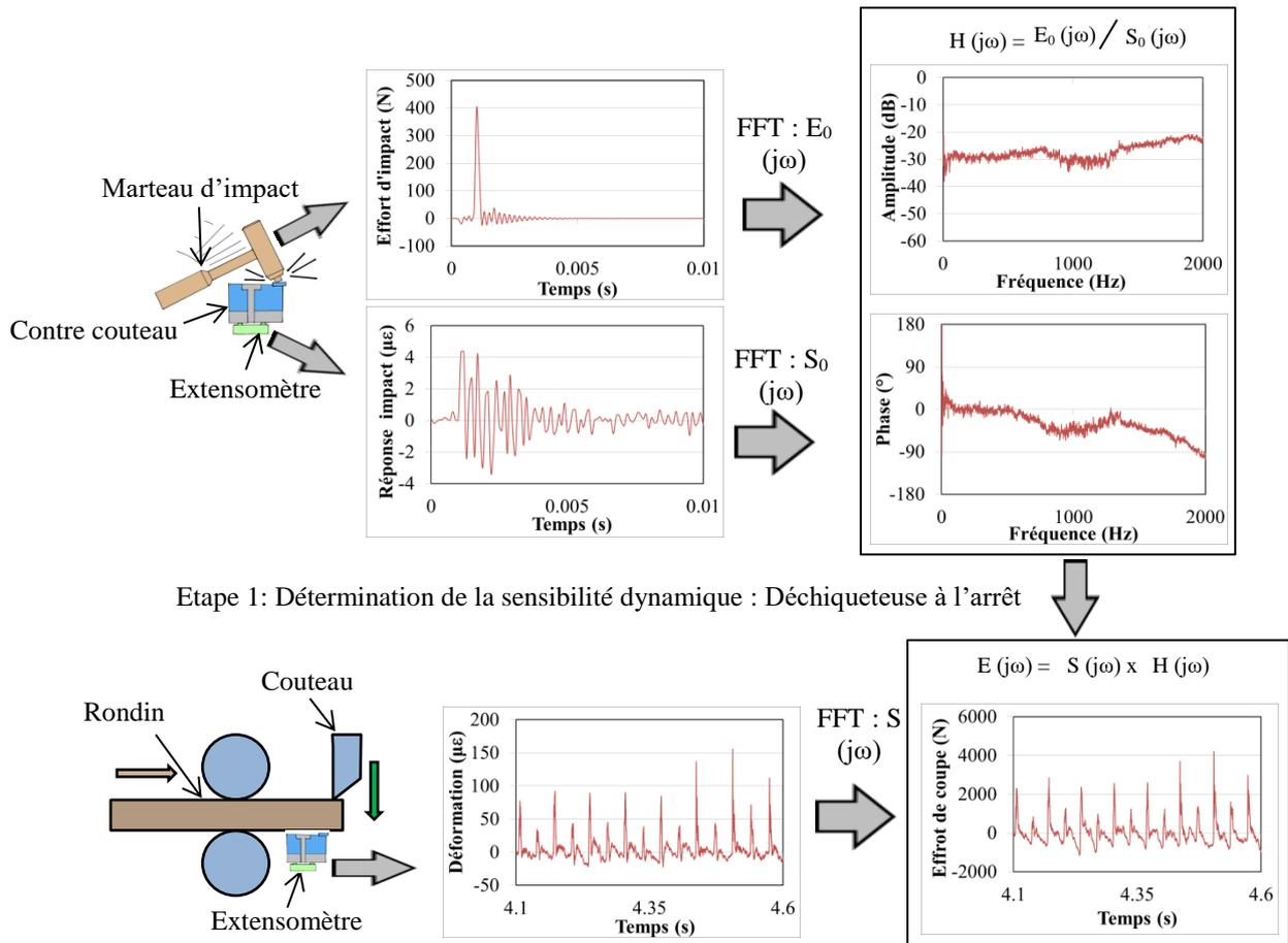
Etape 1 : Détermination de la sensibilité dynamique : Déchiqueteuse à l'arrêt
