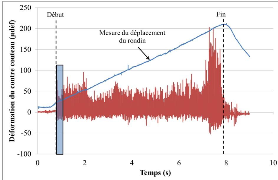
a. Allure de la mesure de la déformation au niveau du contre couteau lors d'un essai
