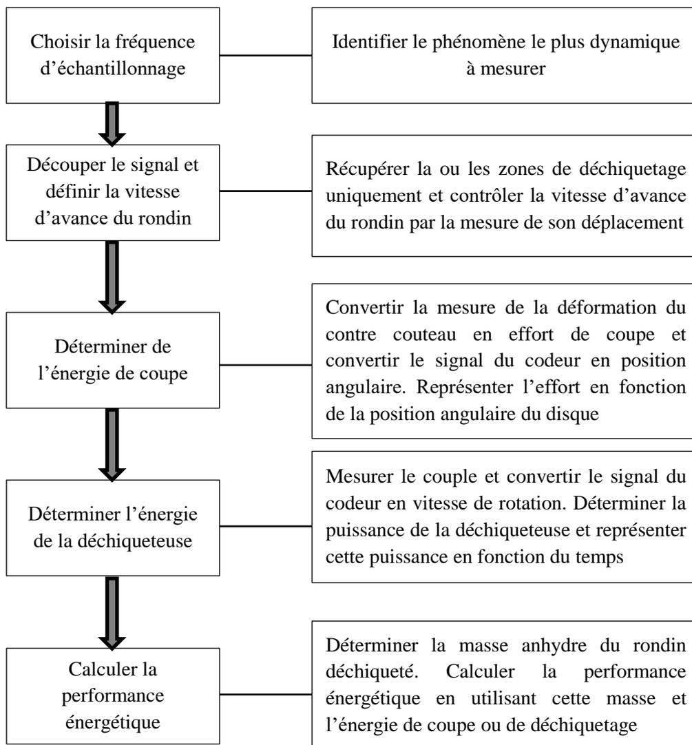
**Figure 41 : Etapes du traitement des signaux pour la détermination de la performance énergétique**
