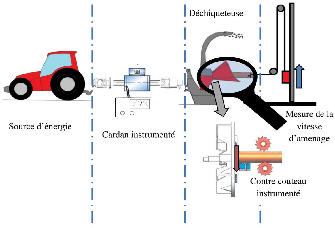
**Figure 33 : Notre système complet de mesure de performance énergétique de coupe et de la déchiqueteuse**
