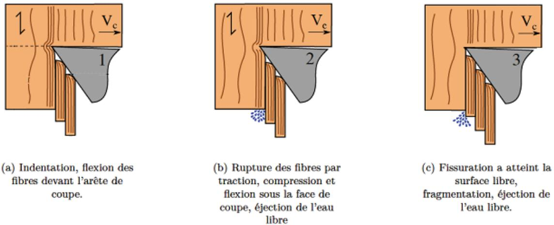
**Figure 21 : Mécanisme de formation des plaquettes [Pfeiffer, 2015]**
