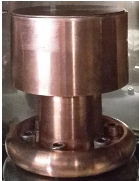
Figure II-2 : Contacts utilisés lors de la première campagne d'essais statiques
