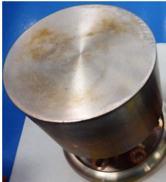
Figure III-20 : Photographie de l'anode à la fin de campagne 2.
