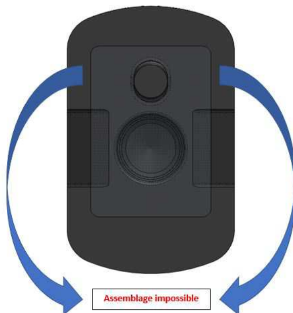
FIG. II.17 – Principe de détrompeur conçu pour l'assemblage de la prothèse
