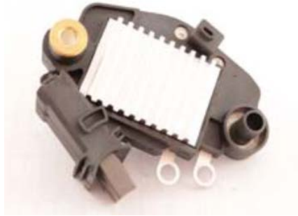
FIGURE 1.13 – Convertisseur DC/DC pour le circuit d'excitation
