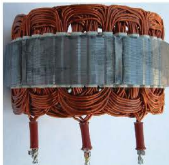
FIGURE 1.8 – Stator 36 encoches d'un alternateur à griffes [8]
