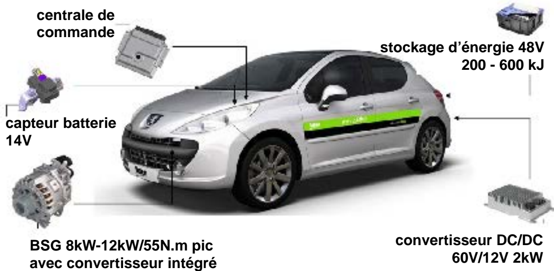
FIGURE 1.6 – Mild-hybrid 48 V de Valeo® : produit Hybrid4All
