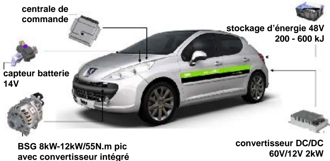
FIGURE 1.6 – Mild-hybrid 48 V de Valeo ® : produit Hybrid4All
