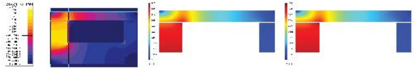
FIGURE 3.8 – Induction au sein de l'électroaimant : Flux2D ® , Gmsh-GetDP ( U_m - \varphi_p ), Gmsh-GetDP ( U_m - V_p )
