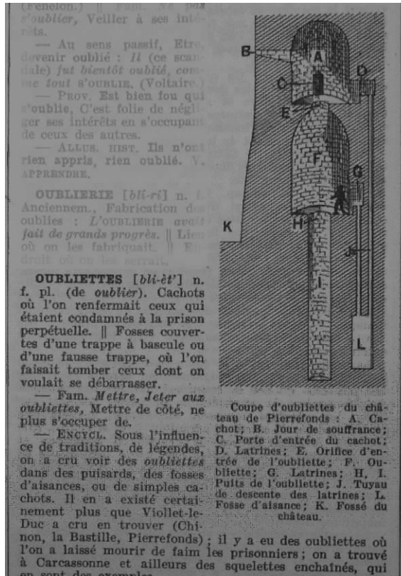
Fig. XXXV. Schéma de l'oubliette exécuté par Viollet-le-Duc et repris dans les deux dictionnaires Larousse à 2 ou 6 vol., de 1922 et 1928.
