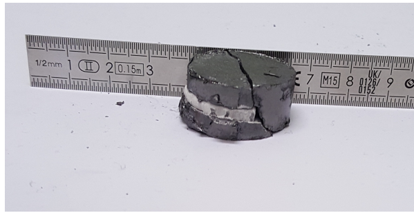
FIGURE V.15 – Macrographie d'un module thermoélectrique fritté en dispositif horizontal avec séparateur en poudre d'alumine
