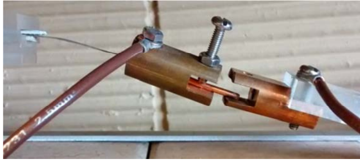
Figure 3-18 : Pont vibrant Mono touche IJL
