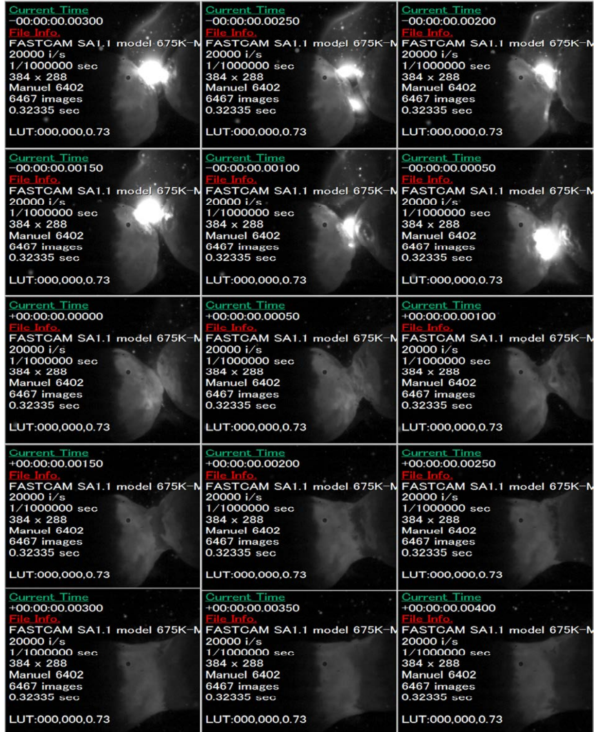
Figure 1-28 : Contact par fusion de pont fondu Electrode Fe, Iarc=18A, Pression ambiante, Temps de pause 1µs
