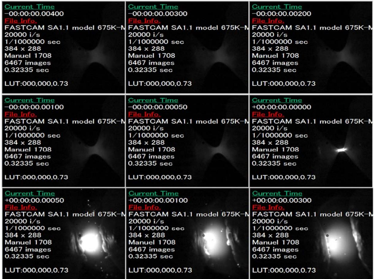
Figure 1-26 : Ouverture de contact par rétraction de pont fondu Electrode Fe, I=20A, Pression ambiante, Temps de pause 1 \mu s
