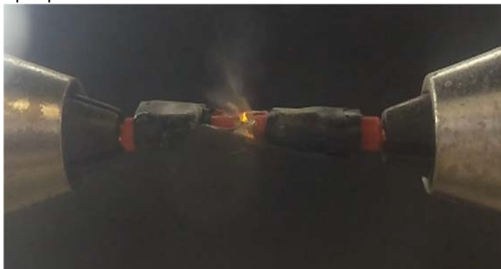
Figure 3-19 : Arc par pont salin sur brèches de 2mm
