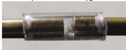
Figure 3-4 : Pont par laine de fer (UL1699b)
