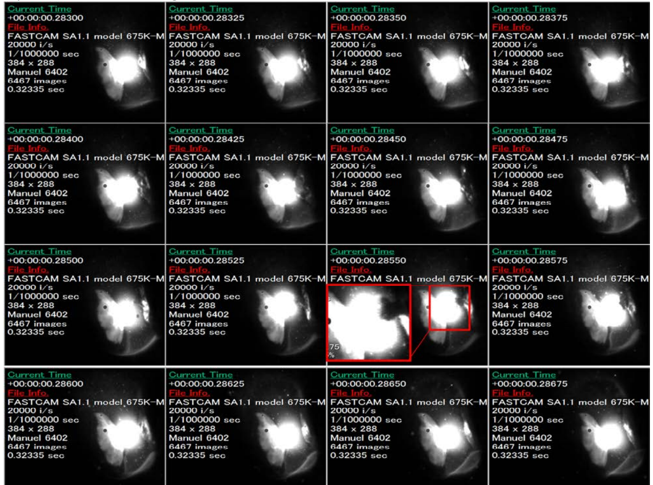
Figure 1-38 : Soufflage du métal en fusion sur l'anode par le gaz ionisé en cathode Décharge 18A, électrode fer, écartement <2mm Temps de pause 1µs
