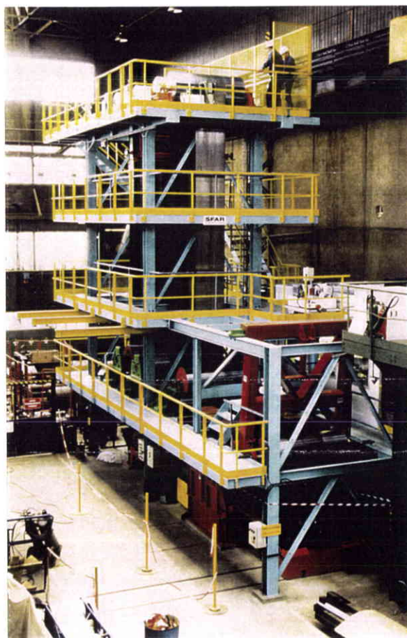
photo 2: installation expérimentale à grande échelle de formation de plis
