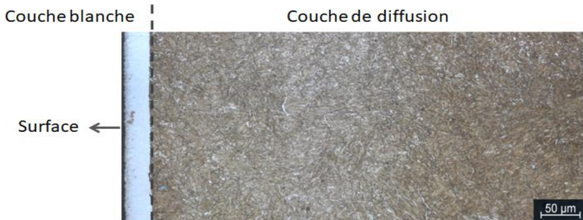
Figure III-3 : Micrographie optique d'une coupe transverse de la proche surface de la couche nitrurée obtenue après la nitruration de référence (attaque Nital 2 %).
