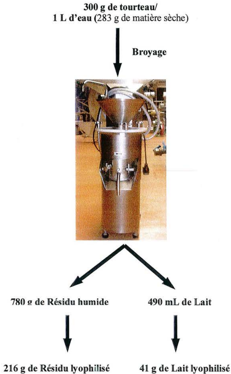
Figure 24 : Bilan matière de la production de lait de noix du Brésil
