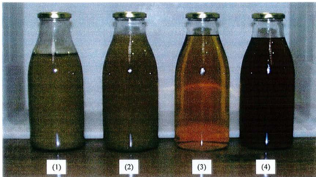
Photo 1 : Jus non pasteurisés : (1) jus initial non filtré, (2) retentât, (3) jus micro-filtré, (4) jus concentré par osmose inverse.
