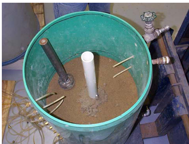
Figure 6.9 : Mise en place locale autour du puits d'un bouchon plus concentré en bentonite pour s'assurer d'éviter des écoulements préférentiels.
