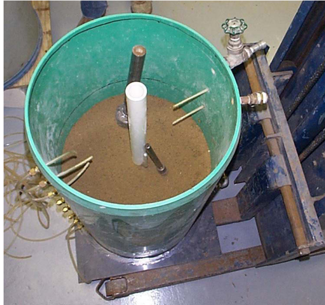
Figure 6.8 : Mise en place de l'aquitard (couches placées successivement, puis compactées à l'aide d'une masse).
