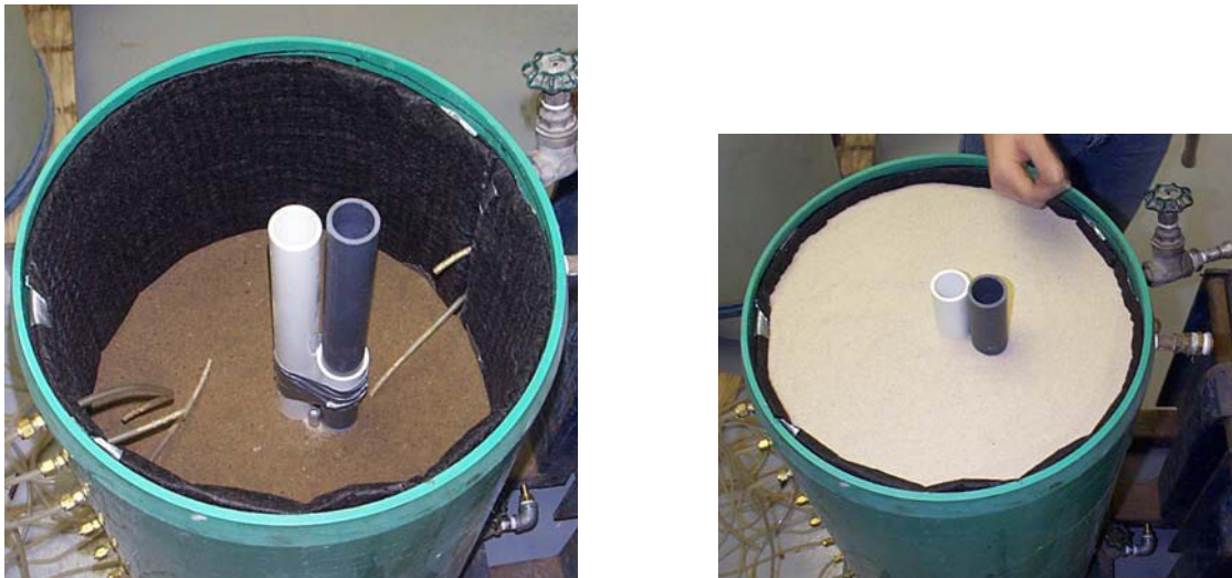
Figure 6.10 : Positionnement du piézomètre avant la mise en place de l'aquifère 1 (photographie de gauche) et fin de la mise en place de l'aquifère 1 (photographie de droite).
