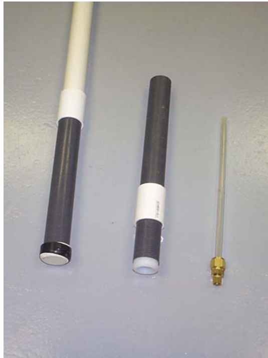
Figure 6.5 : De gauche à droite : Le puits et sa crépine, le piézomètre (ou puits d'observation) et sa crépine, et le petit tube en plexiglas qui, rempli de sable, représentera le défaut de scellement.
