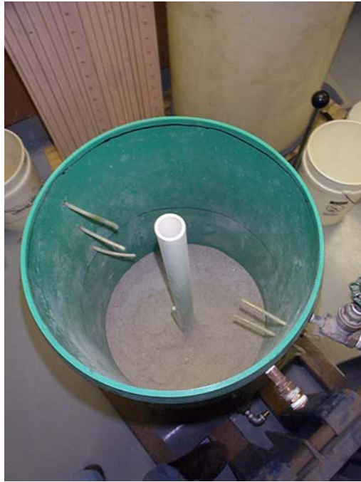
Figure 6.7 : Positionnement du tube en plexiglas dans la cuve après la mise en place de l'aquifère 3.
