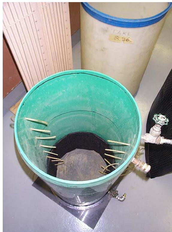
Figure 6.4 : Mise en place du géotextile constituant la frontière de l'aquifère.
