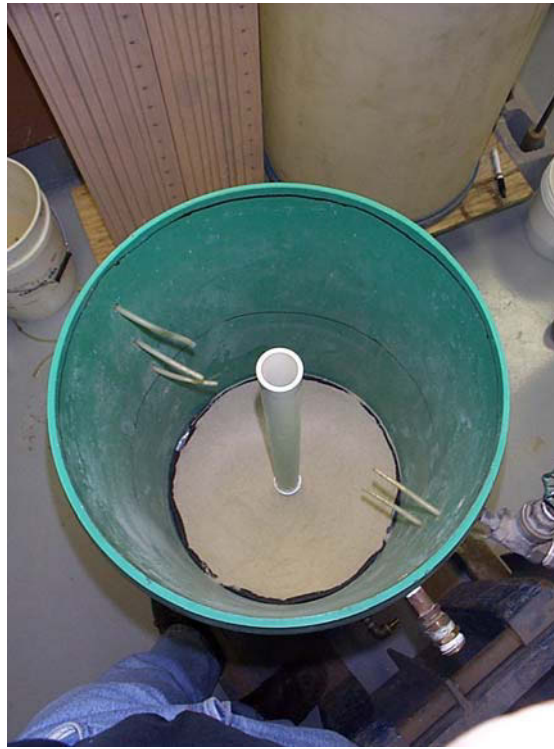
Figure 6.6 : Mise en place de l'aquifère 3 avec le sable 00WG.
