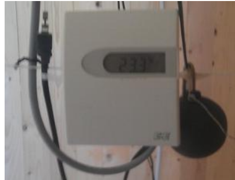
SHT 75, capteur CO 2 et boule noire
