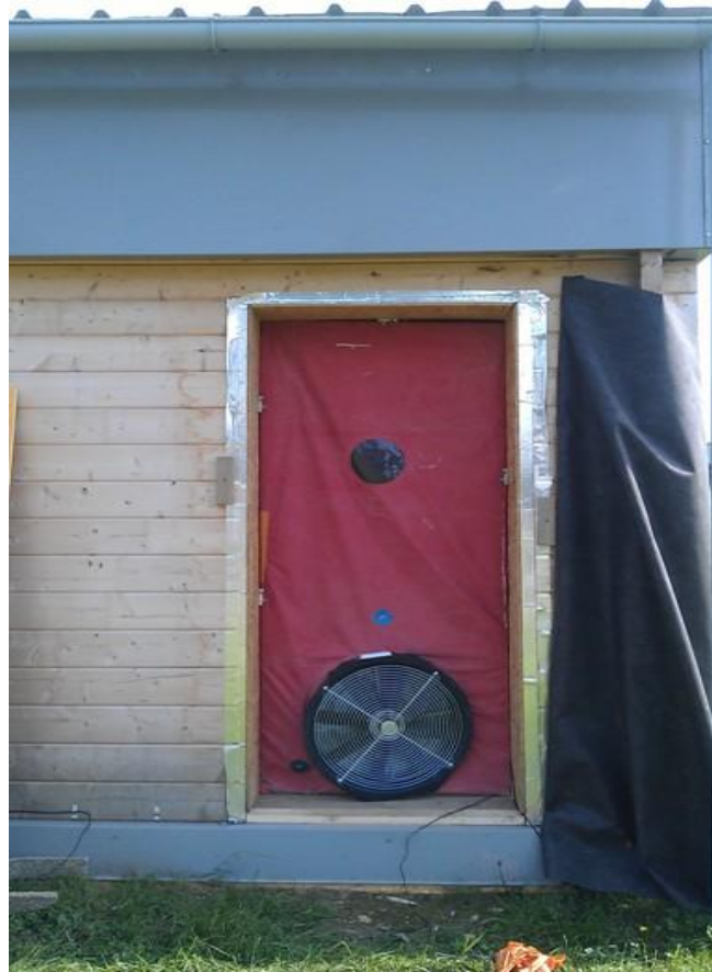
Figure 54. Mesure de perméabilité à l'air sur un module
