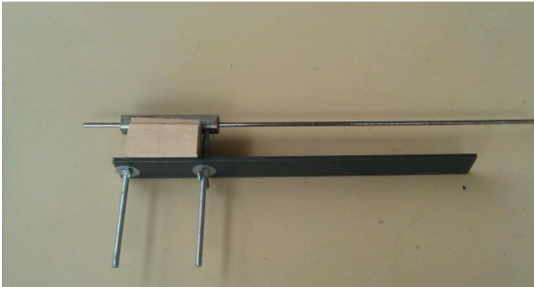
Figure 20. Système d'implantation des capteurs dans la paroi
