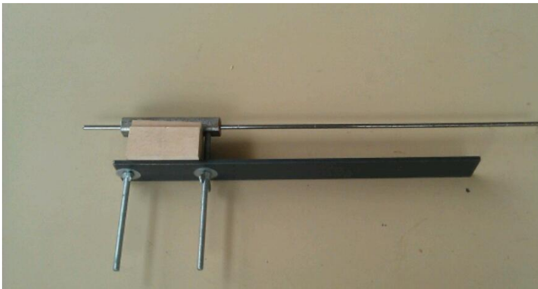
Figure 20. Système d'implantation des capteurs dans la paroi
